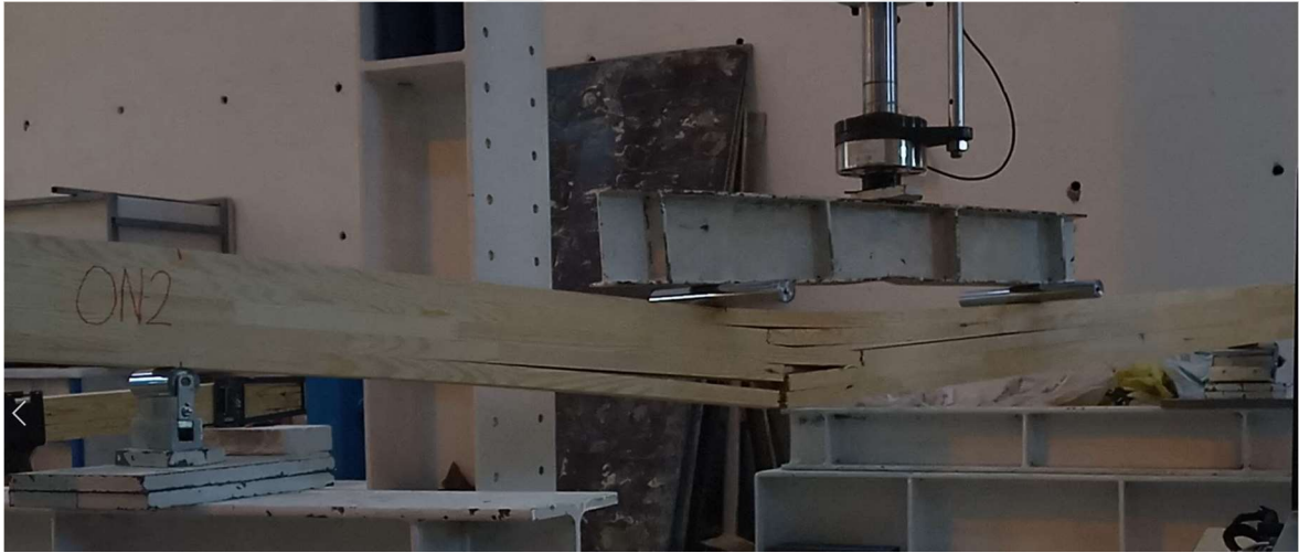
Şekil 4.1 : Referans (0N) lamine ahşap kirişin hasar biçimi
