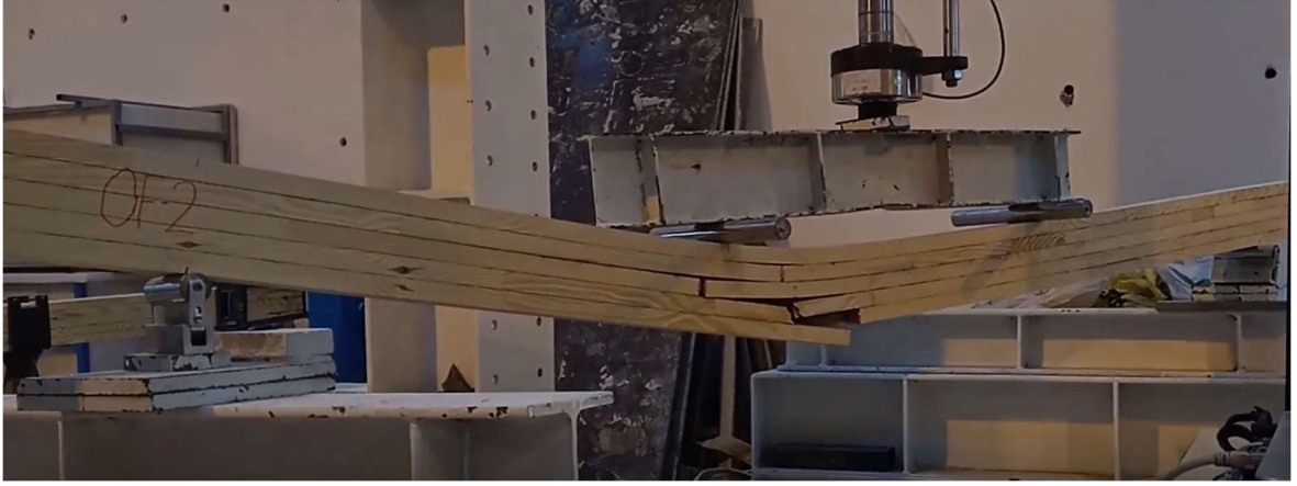
Şekil 4.6 : CFRP ile güçlendirilmiş referans lamine ahşap kirişin (0F) hasar biçimi
