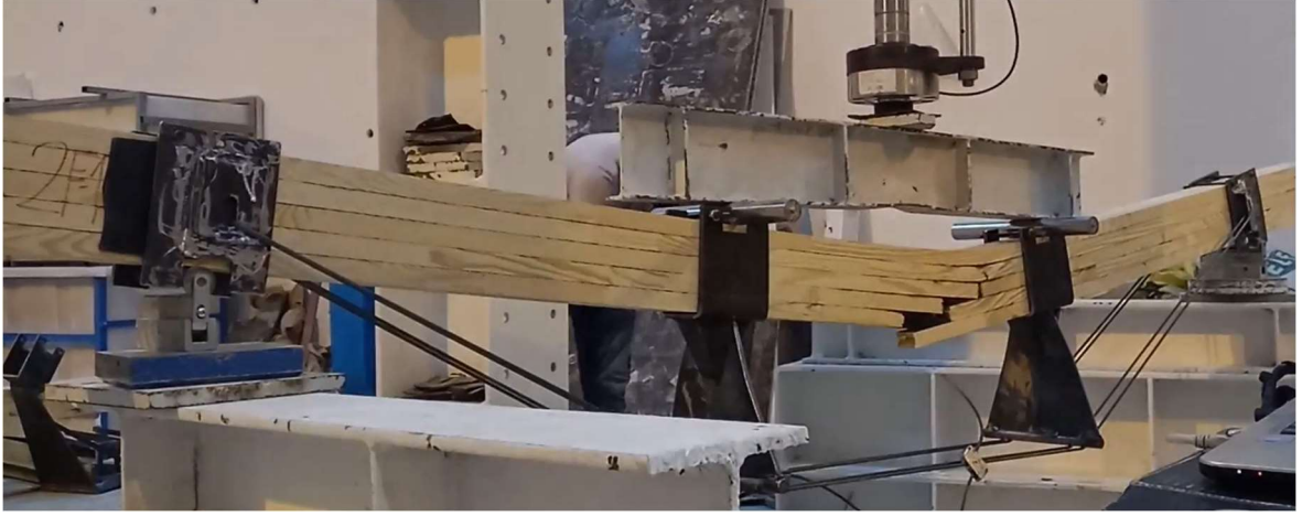
Şekil 4.8 : 2 Numaralı çelik halat ve CFRP ile güçlendirilmiş lamine ahşap kirişin (2F) hasar biçimi
