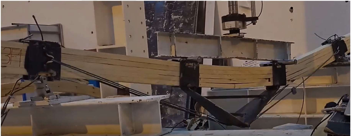
Şekil 4.9 : 3 Numaralı çelik halat ve CFRP ile güçlendirilmiş lamine ahşap kirişin (3F) hasar biçimi
