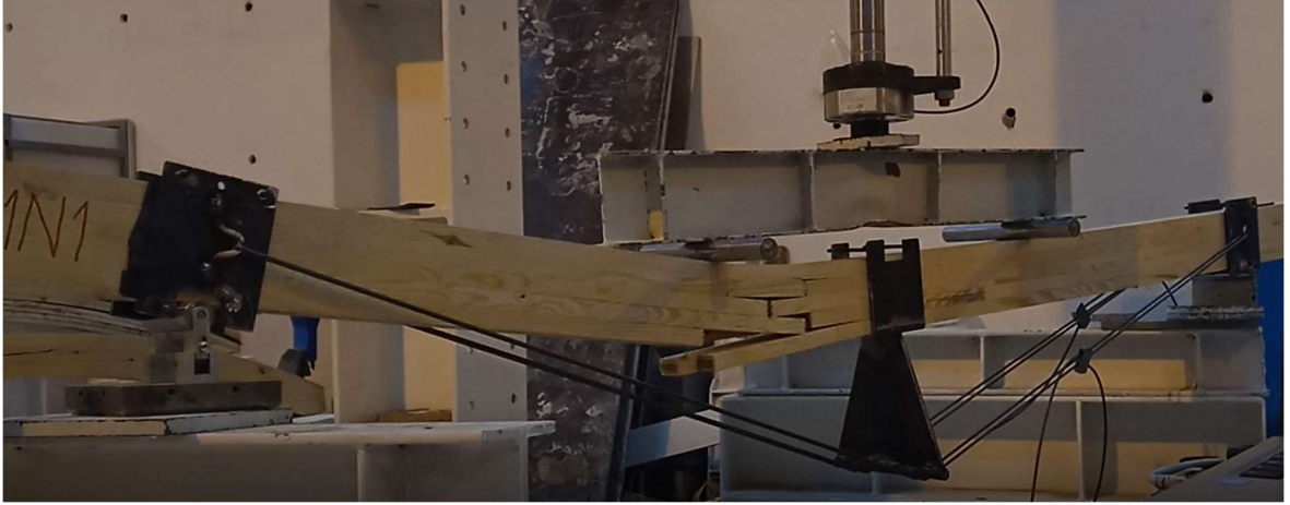
Şekil 4.2 : 1 Numaralı (1N) çelik halat ile güçlendirilmiş lamine ahşap kirişin hasar biçimi
