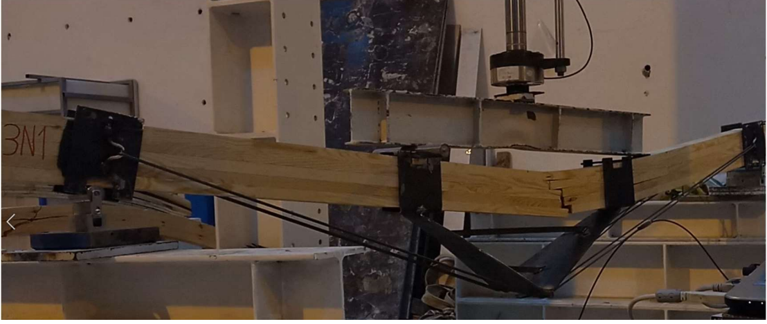
Şekil 4.4 : 3 Numaralı çelik halat ile güçlendirilmiş lamine ahşap kirişin hasar biçimi
