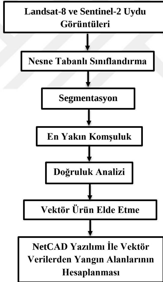
Şekil 4.27 Nesne tabanlı sınıflandırma yöntemi iş akışı.
