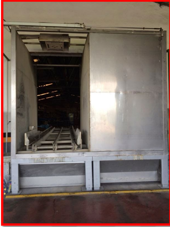
Şekil 3.5. Portakallara derim sonrası farklı fungusit uygulamalarının yapıldığı drencher sistemi
