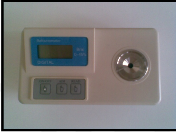
Şekil 3.10. SÇKM ölçümleri için kullanılan dijital refraktometre
