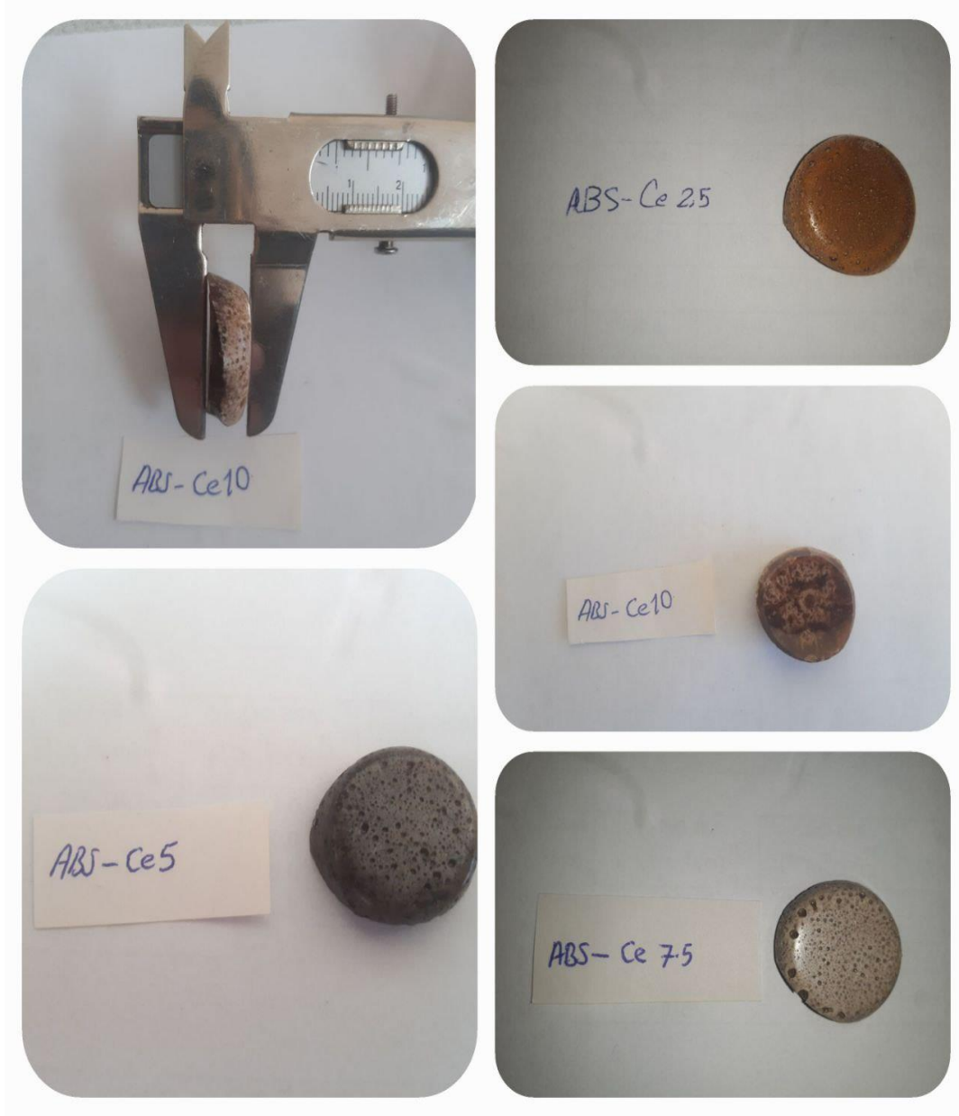
Şekil 3.1. Gama ışını testlerine tabi tutulan numunelerin geometrik şekli
