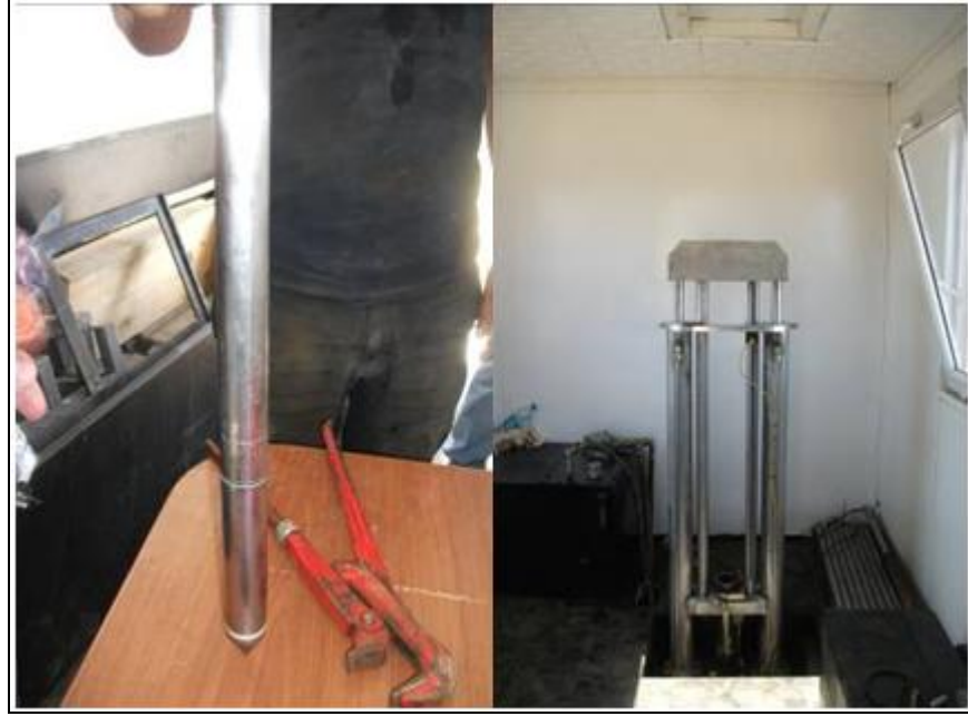
Şekil 3.5. Çalışmada kullanılan konik penetrasyon deneyi ekipmanları
