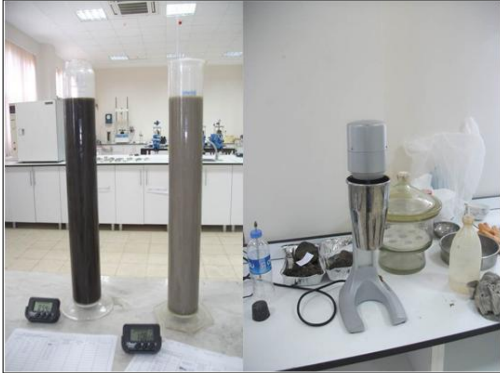
řekil 3.12. Hidrometre deneyinde kullanılan mezr, kronometre ve mekanik karıřtırıcı
