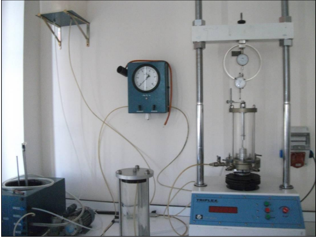
Şekil 3.14. Üç eksenli basınç deneyi düzeneği
