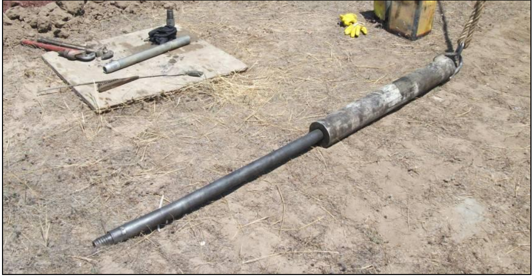
Şekil 3.2. SPT deneyinde kullanılan güvenli şahmerdan (safety hammer)
