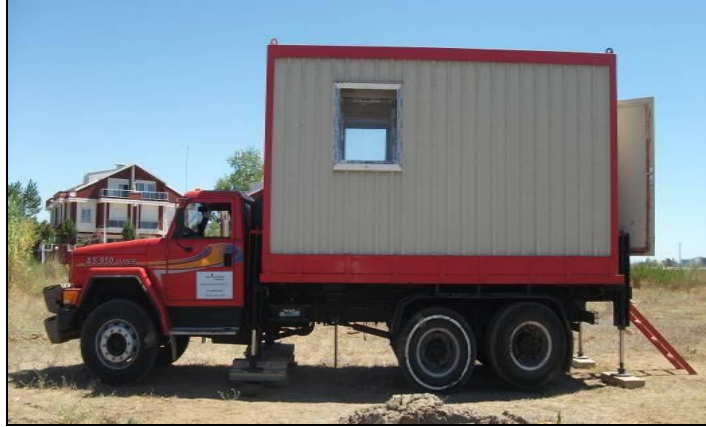
Şekil 3.6. Konik penetrasyon deney düzeneğinin yerleştirildiği kamyon
