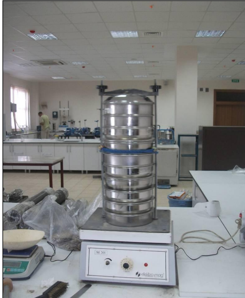
Şekil 3.11. Elek analizi deneyinde kullanılan farklı \phi aptaki elekler ve sarsma makinesi
