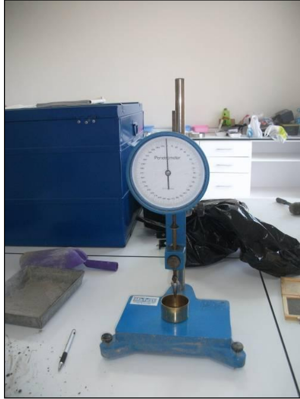
Şekil 3.13. Likit limit deneyinde kullanılan penetrometre cihazı
