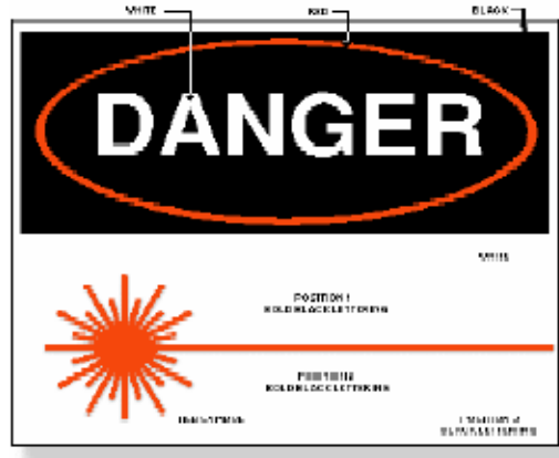
Şekil 4.13. DANGER (Tehlike) : Sınıf 3a, 3b ve 4 laserler için ikaz levhası (30)
