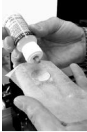
Resim 4.28. Temizlik sıvısının damlatılması (40)
