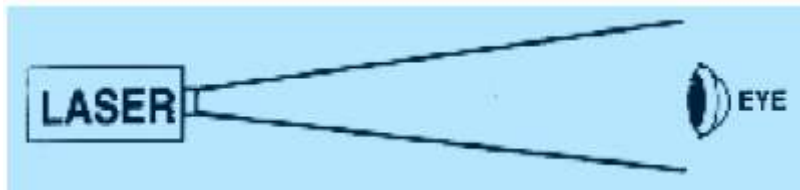
Şekil 4.2. Esas (yansımamış) birincil laser ışınına gözün doğrudan maruz kalması (30)
