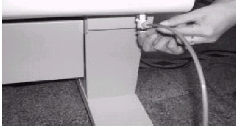
Resim 4.15. LaserPro Explorer hava hortumunun makineye bağlantısı (40)
