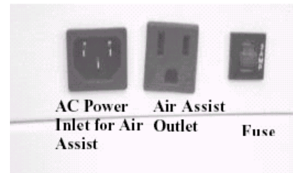
Resim 4.9. LaserPro Explorer sağ yan anahtar ve giriş görünüşleri (40)
