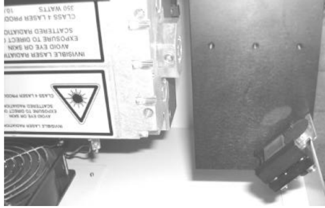
Resim 4.19. 1 numaralı aynanın koruyucu kapaksız görüntüsü. (40)
