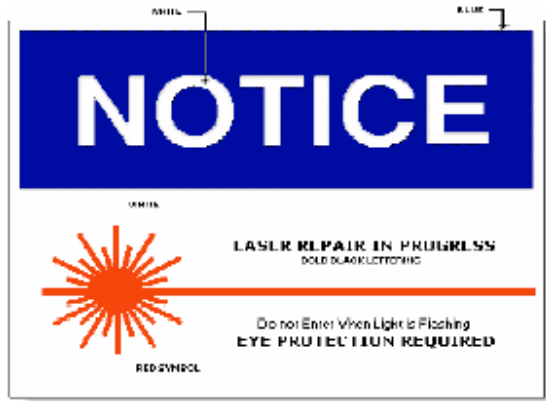
Şekil 4.12. NOTICE (Duyuru) : Geçici laser kontrol bölgesinin dışarısında kullanılan örnek duyuru levhası (30)
