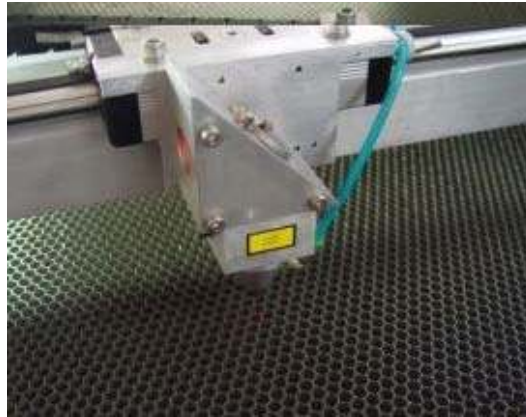
Resim 4.31. Bal peteği şeklindeki çalışma tablası (43)
