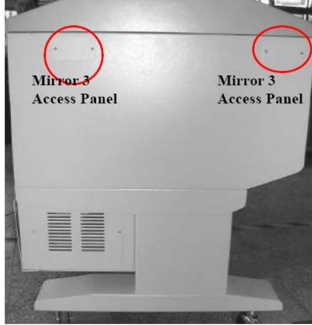
Resim 4.21. 2 ve 3 numaralı aynanın makinenin sol yanındaki yerleri (40)
