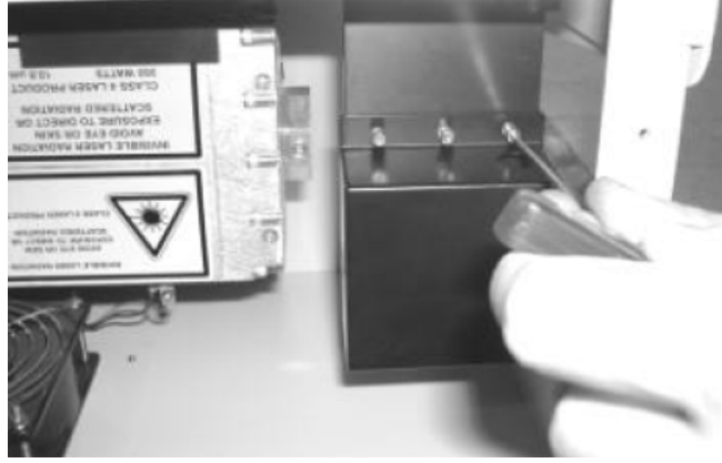
Resim 4.18. 1 numaralı aynanın koruyucu kapağının sökülmesi. (40)
