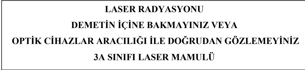
Şekil 4.8. 3a Sınıfı laser etiketi
