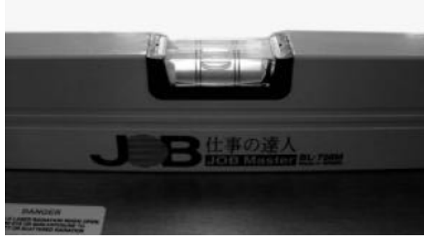
Resim 4.3. Makine teraziye alınarak yerleştirilmeli (40)
