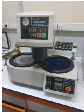
Şekil 5.8. Metkon Forcipol 2V zımpara ve parlatma cihazı ile Forcimat otomatik tutucu kafa
