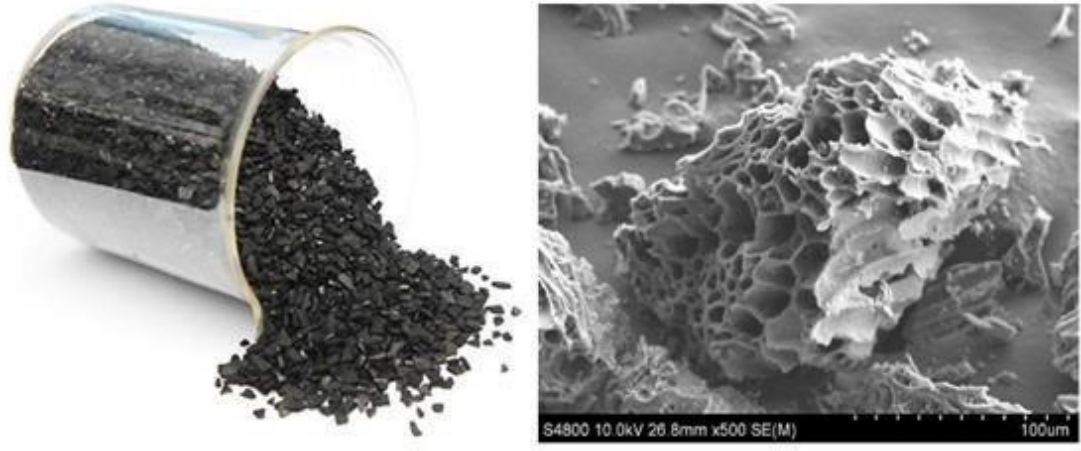
Şekil 1.6. AC'nin gözenekli yapısı.
