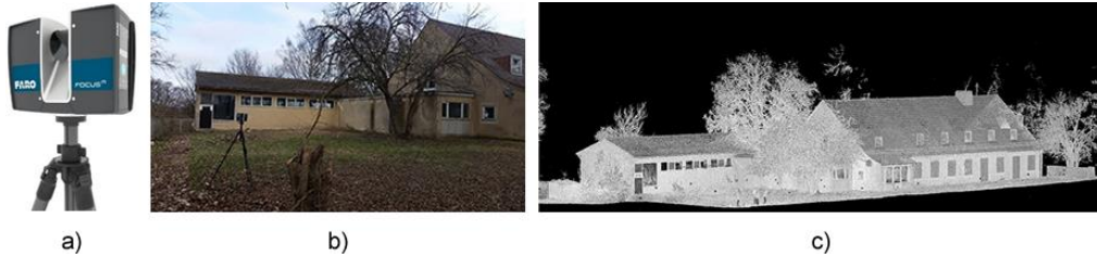
Şekil 2.11. a) Faro Focus lazer tarayıcı cihazı b) Bir dış mekânın RGB görüntüsü c) Faro Focus cihazı ile taranan mekândan yansıyan yoğunluk verilerinden oluşturulmuş 3B nokta bulutu [123,124]
