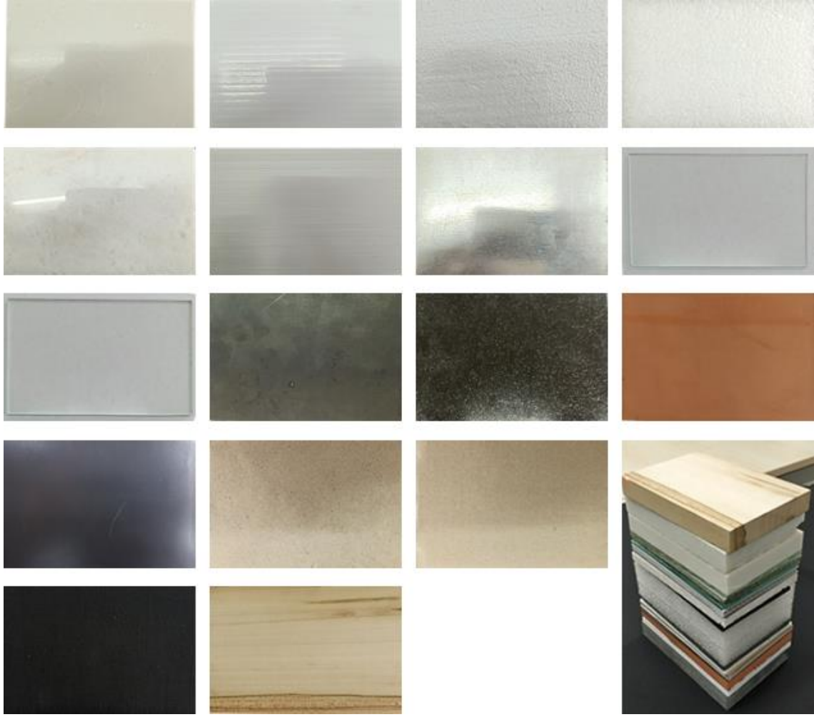
Şekil 6.2. Deneysel çalışmada kullanılan cansız materyaller. Soldan sağa sırasıyla; yapay mermer, pvc, polistiren, polietilen, mermer, alüminyum, galvaniz, cam, buzluca, demir, granit, çömlek, magnet, mdf, mukavva, siyah kumaş, ıhlamur
