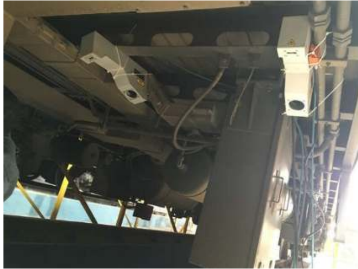
a) İki adet lazer kameranın trene yerleştirilmesi
