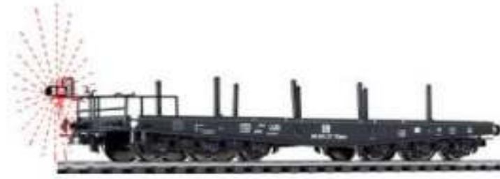
a) Flatcar'ın tek bir profil tarayıcısına ait şematik diyagramı
