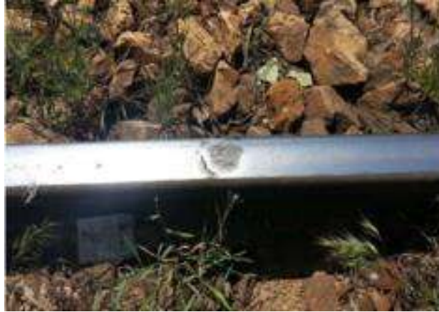
Şekil 1.6. Ray oyulma türü arıza
