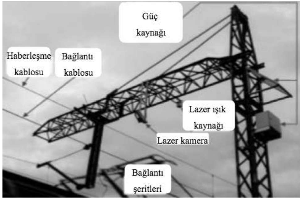
Şekil 1.13. Lazer tarama muayene sistemi [33].
