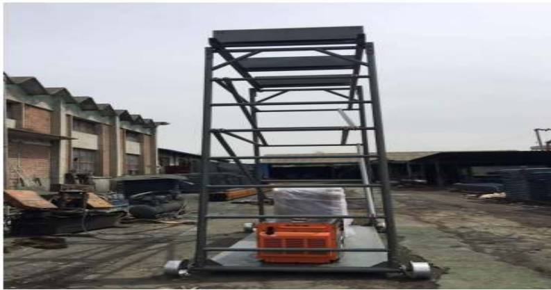
Şekil 1.24. Katener bakım merdiveni [42].
