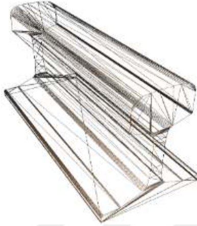
a) Üç boyutlu S49 ray profilinin yüzey geometrisi
