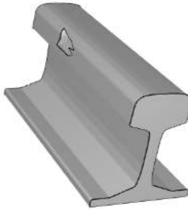
c) Üç boyutlu arıza içeren S49 ray profili
