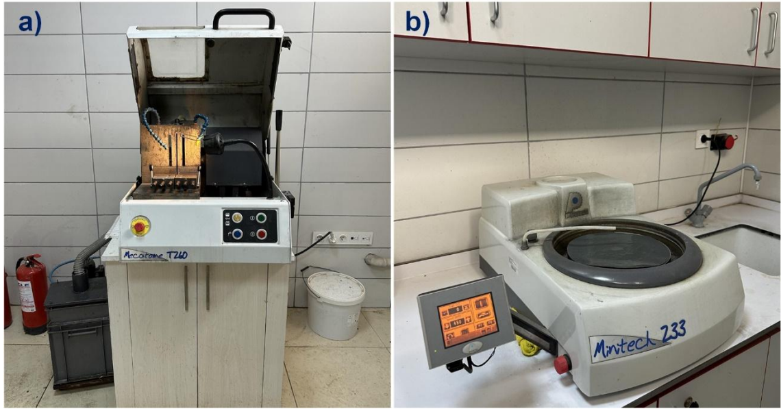
Şekil 3.8. Kesme cihazı (a) ve parlatma cihazı (b)
