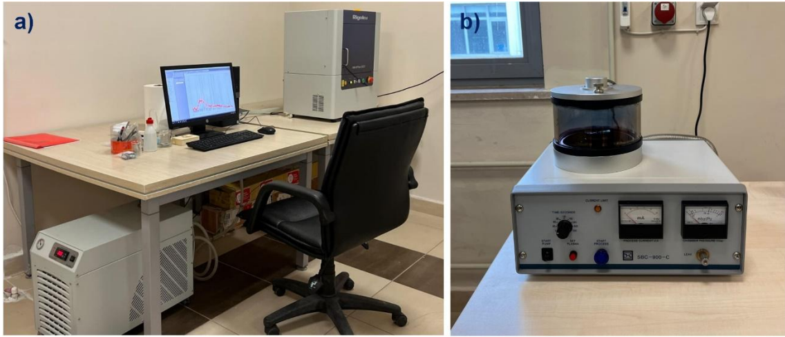
Şekil 3.12. X-ışını difraksiyonu analiz cihazı (a) ve toz numune kaplama cihazı (b)
