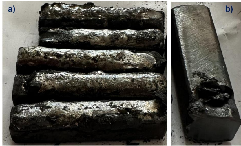
Şekil 3.7. Kaplamalı numuneler (a) ve kaplamasız numune (b)
