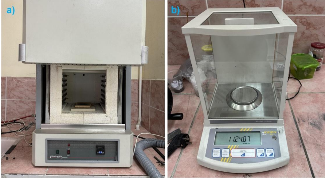
Şekil 3.3. Tav fırını (a) ve hassas terazi (b)
