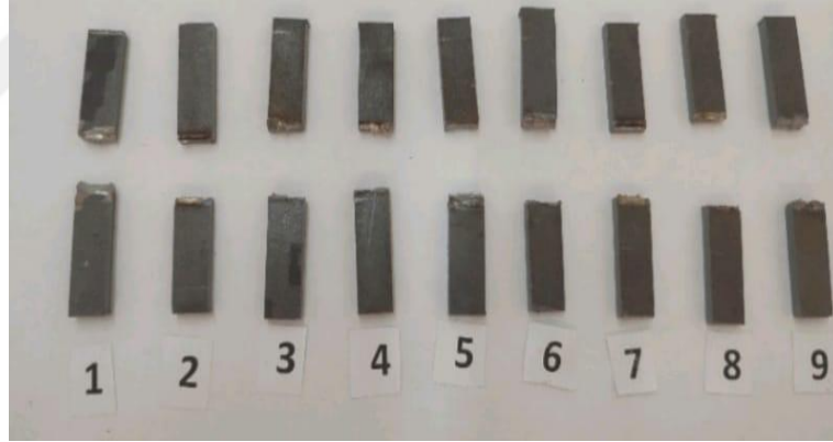
Şekil 5.3 Lazer kaynağı yapılmış olan 9 adet çentik darbe deney numunelerin kopma bölgesinin görüntüsü.
