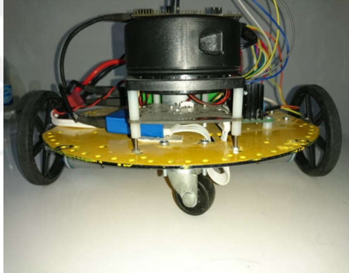
Şekil 6.4. Tasarlanan robotun önden görünümü ve lidarın yerleşimi
