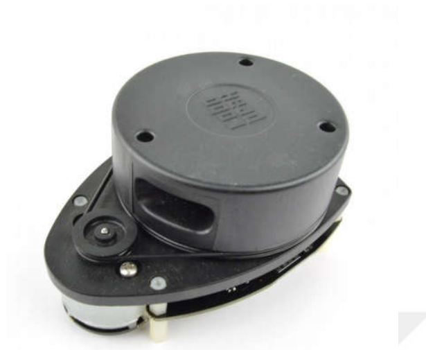
Şekil 4.5. Ortam haritalaması ve uzaklık ölçümü için kullanılan lidar
