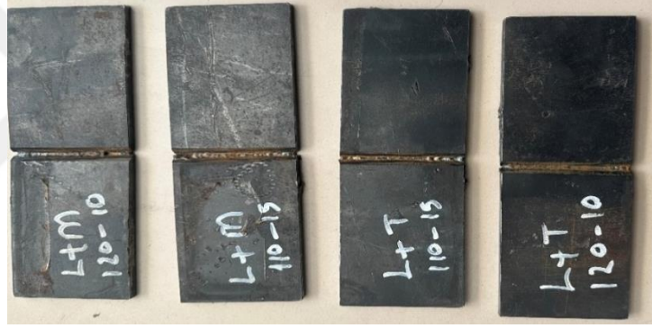
Şekil 3.9. Lazer kaynak sonrası bazı numunelerin görüntüleri
