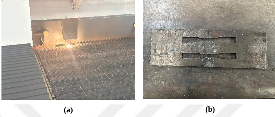
Şekil 3.19. (a) Lazer kesim işlemi, (b) kesim sonrası görüntü
