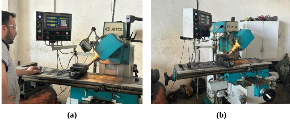
Şekil 3.5. (a) Freze cihazı görüntüsü, (b) kaynak ağzı açılması işlemi
