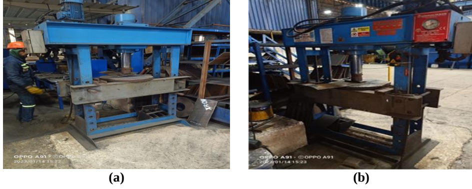
Şekil 3.2. (a) Doğrultma pres makinası, (b) malzemenin plaka haline getirilmesi
