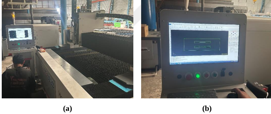
Şekil 3.18. (a) Lazer kesim makinesi, (b) kesim öncesi numune boyutlandırma çizimi
