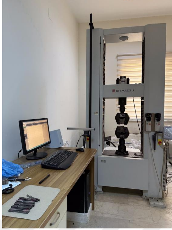
Şekil 3.22. Shimadzu marka çekme testi makinesi
