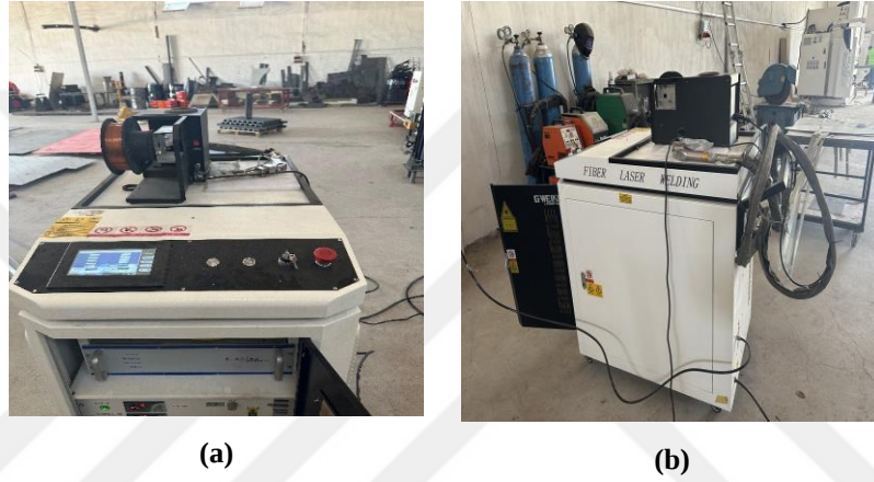
Şekil 3.7. (a) ve (b) lazer kaynak makinası gösterimi
