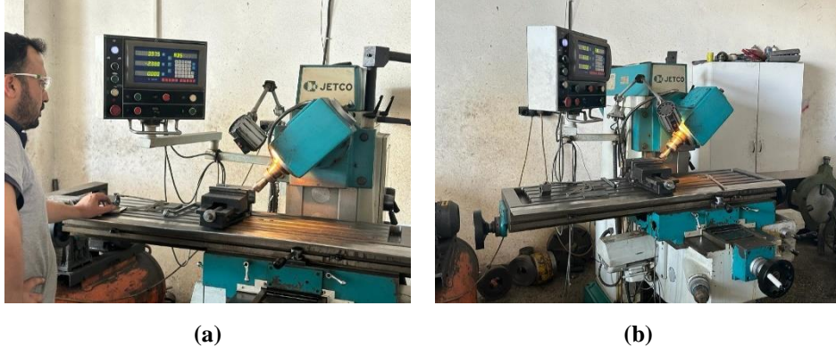
Şekil 3.5. (a) Freze cihazı görüntüsü, (b) kaynak ağızı açılması işlemi
