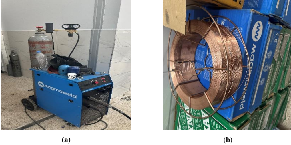
Şekil 3.10. (a) MIG kaynak cihazı, (b) kaynak için kullanılan tel
