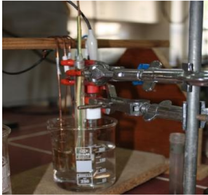
Şekil 3.5. Çalışmada kullanılan 3 elektrotlu ıslak hücre düzeneği
