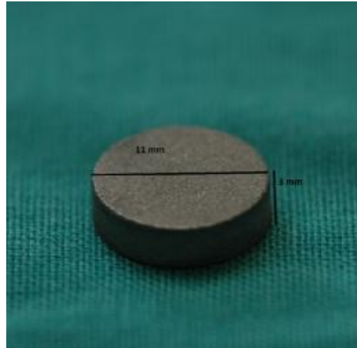
Şekil 3.2. Elektrokimyasal testler ve element salınımı deneylerinde kullanılan örnek boyutları
