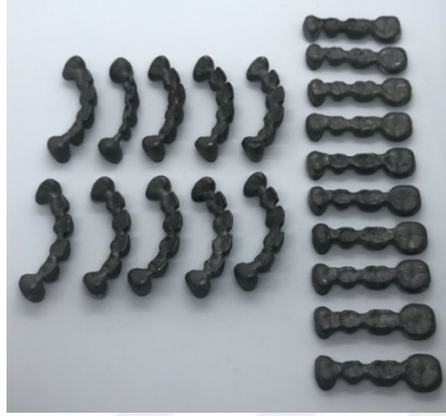
Şekil 3-21: Mum modelajların döküm işlemi sonrası görüntüsü
