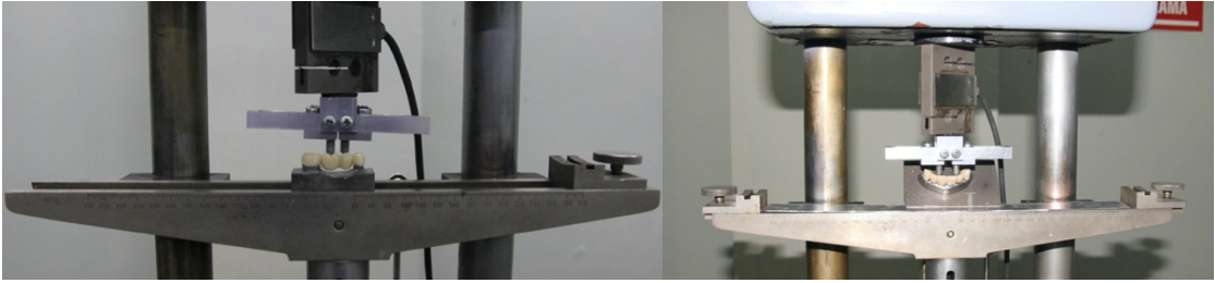
Şekil 3-53: Köprü restorasyonlarının universal test cihazındaki görüntüsü
