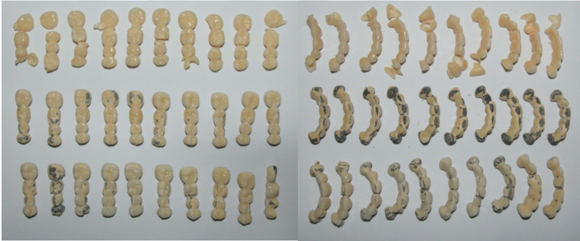
Şekil 3-54: Köprü restorasyonlarının kırma işlemi sonrasındaki görüntüleri
