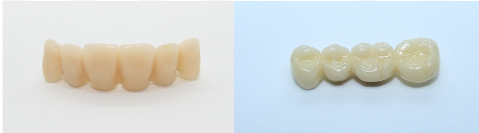
Şekil 3-47: Venerlemesi tamamlanmış zirkonya altyapılı örneklerin görüntüsü
