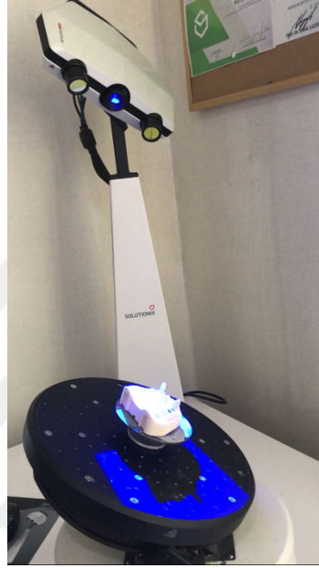
Şekil 3-4: Modellerin yüksek çözünürlüklü endüstriyel tarayıcı ile taranması
