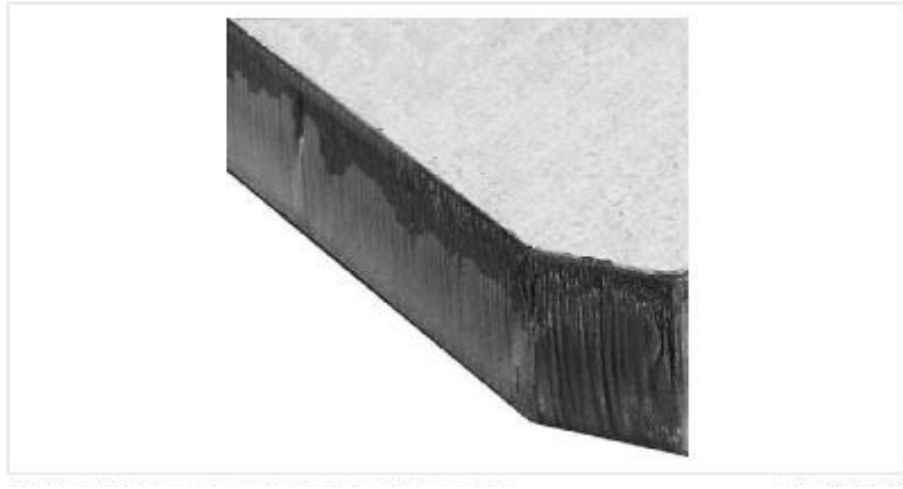
Şekil 1.26 Oksijen kullanılan kesimde kesme yüzeyi ve oksit tabakası
