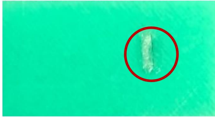
Şekil 42. UV lazer deneme işlemi (yüzey ergimesi gözlemlendi)
