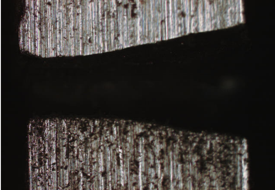
Resim 5.35. 2 mm kalınlık, 2500 W, 2 inç, 14 bar, 1200 Hz için elde edilen kesit, x 50 büyütme (21444_5 nolu parametre) [18]
