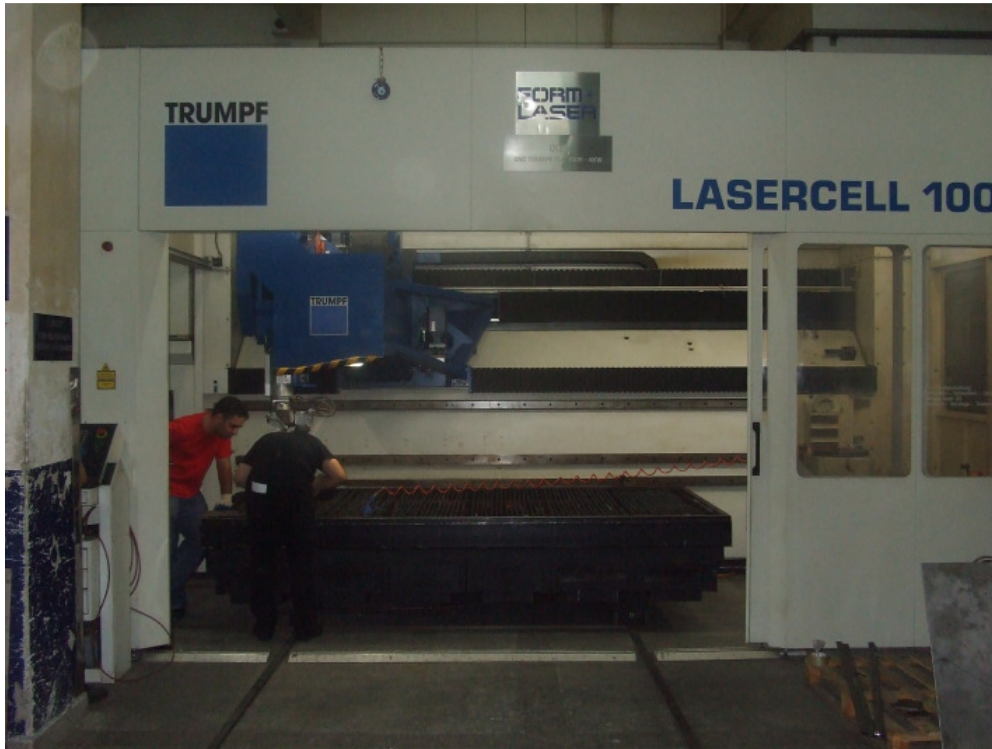
Resim 3.2. Trumpf marka Truflow 4000 model CO 2 lazer ünitesi ve Lazercell 1005 model kaynak tezgahı
