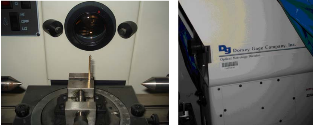
Resim 6.6. Dross yüksekliği ölçümü için kullanılan optik ölçüm cihazı
