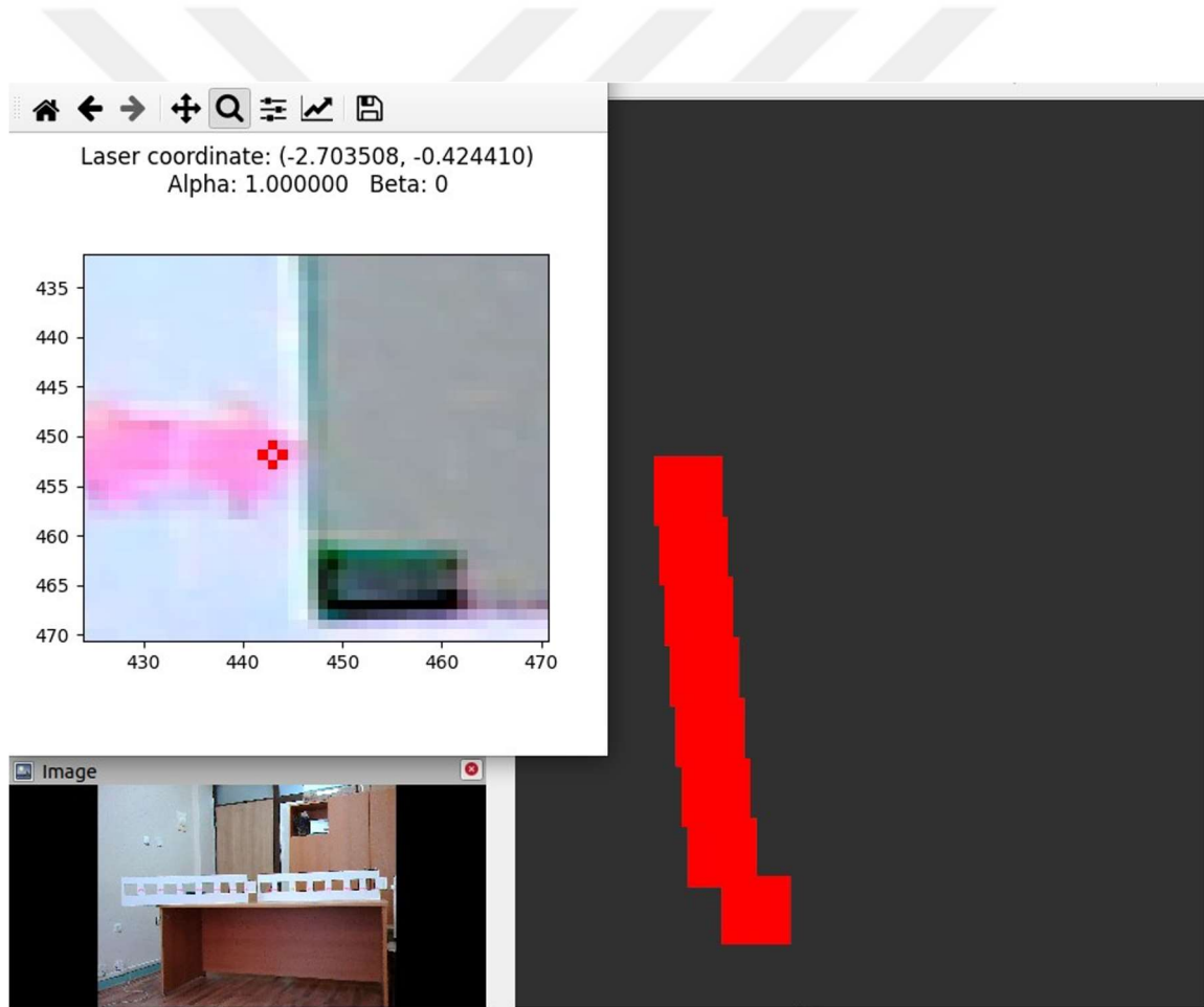
Şekil 28. Lazer koordinatı ile koordinata karşılık gelen kamera koordinatının RViz üzerinde işaretlenmesi
