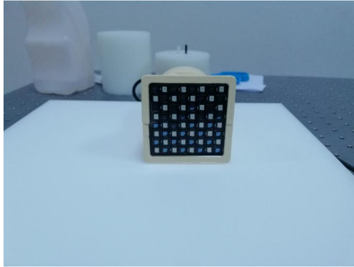
Şekil 3. 2. LED-Fotodiyot Difüz Optik Tomografi Sistemi.
