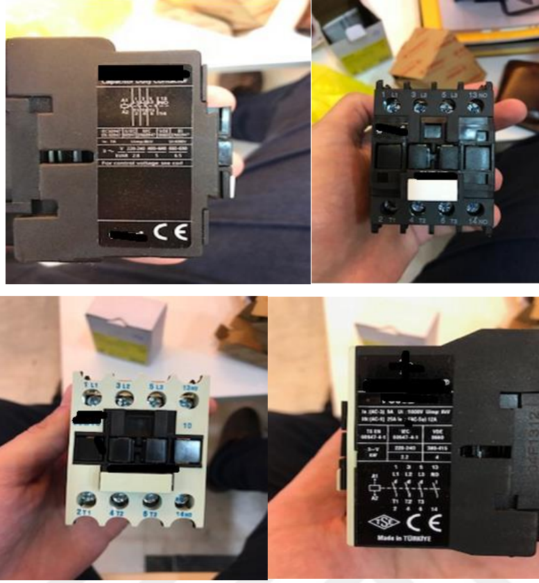
Şekil 3.4 Deneyde kullanılan AC-5a (Altta) ve AC-6b (Üstte) sınıfı 2 adet kontaktör.
