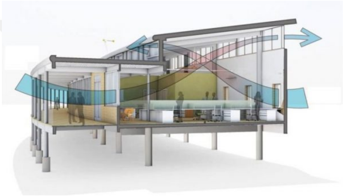
Şekil 5.9. Doğal Havalandırma Hava Akışı Örneği (Havalandırma Sistemleri, 2022)
