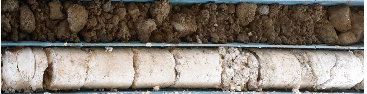
Şekil 2.5. Çakıltaşları (üstte) altına uyumsuz olarak gelen marn seviyeleri (altta, beyaz-krem renkli), (kuyu adı: MD-3, karot çapı: 6,35 cm)
