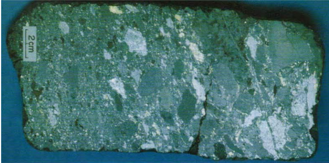
Şekil 2.59. MacLean Extension cevher kütlelerinde; felsik volkanik çakıllar ve sülfid çakılları (sfalerit, pirit, kalkopirit) içeren taşınmış polilitik breş-konglomera cevher [98].
