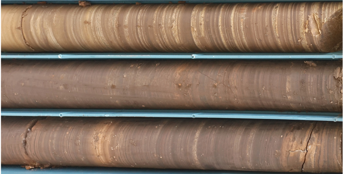
Şekil 1.3. Lefke bölgesindeki maden sondajında (MD-18) kesilen demir ve manganezce zengin Ortatepe Fm. umber seviyelerinde gözlenen bantlı yapı (karot çapı:6,35 cm).
