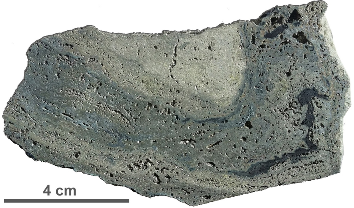
Şekil 2.40. MSC10 el örneğinde görülen kolloform bantlanma ve boşlukları doldurmuş ince taneli (siyah renkte) sülfidler
