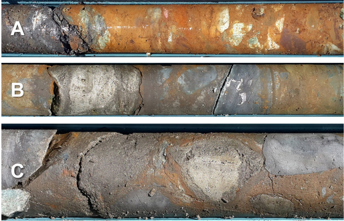
Şekil 2.24. A: MD-33 sondajında tamamen oksitlenmiş breşik cevher. B: MD-11 sondajında çoğunlukla oksitlenmiş-az oranda korunmuş cevher (yaklaşık 10 cm'lik korunmuş masif cevher). C: MD-11 sondajında kısmen oksitlenmiş-kısmen korunmuş cevher. (A için karot çapı: 6,35 cm, B ve C için karot çapı: 8,5 cm)
