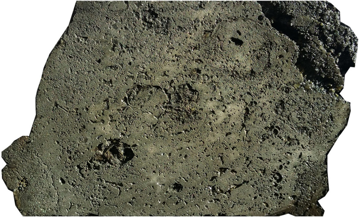
Şekil 2.46. MSC11 örneğinin yarılanmış karot görüntüsü. Boşluklu, süngerimsi yapıda masif sülfür blođu (karot çapı: 6,35 cm).
