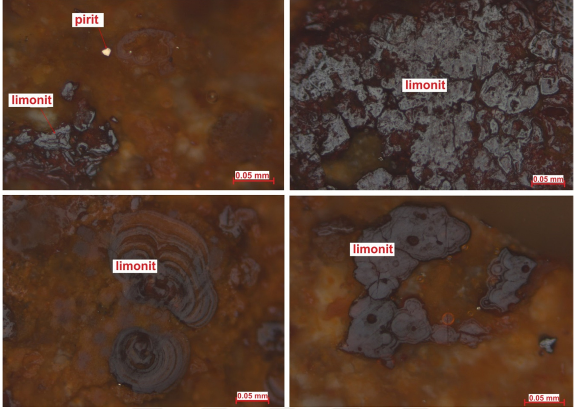
Şekil 2.26. MSC7 örneğinin cevher mikroskobisi incelemesinde gözlenen böbreğimsi şekillerde limonit ve yarı özşekilli pirit (üstte) ile kolloform dokulu limonitler (altta).
