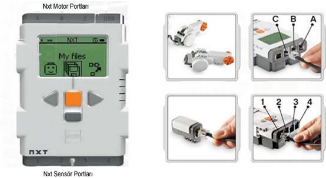
Şekil 2. 10 Lego nxt kitine sensör ve motorların bağlantısı
