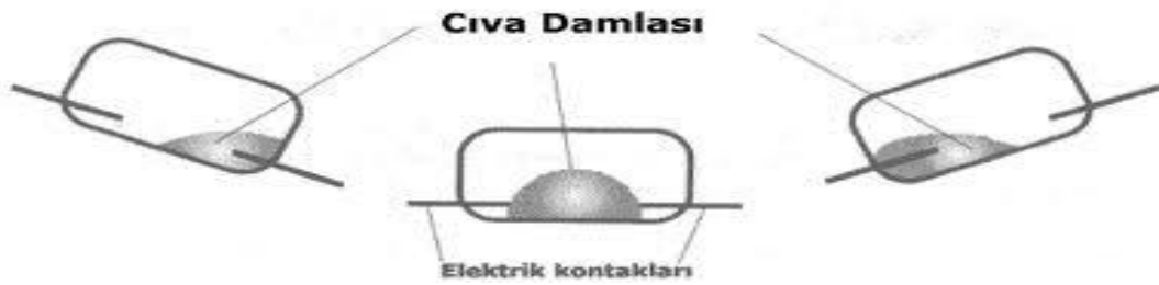
Şekil 2. 4 Eğim denge sensörü çalışma prensibi
