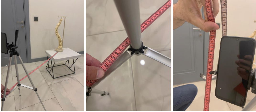
Şekil 26: Omurga maketi-tripot 2 arasındaki mesafe, tripot 2'nin yerden yüksekliği
