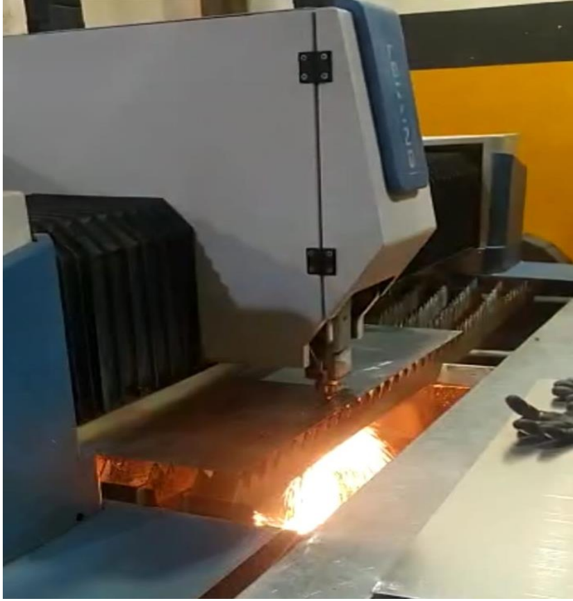
Şekil 4.2. Türbülötörlerin lazer kesim makinesi ile imalatı
