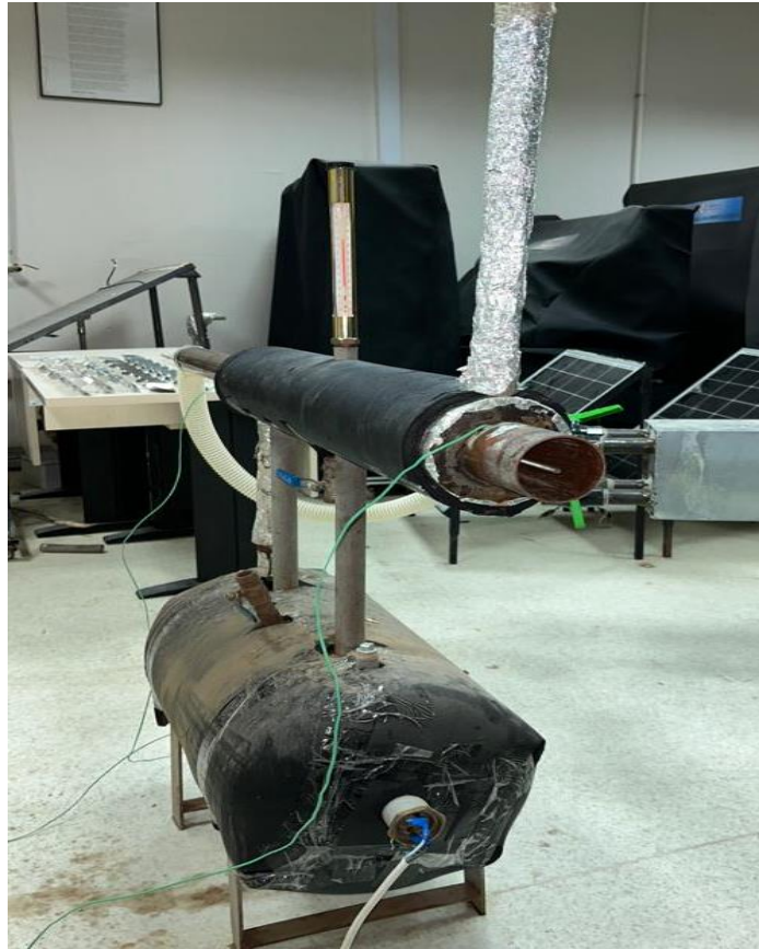
Şekil 4.5. Deneyde kullanılan türbülator yerleşimi
