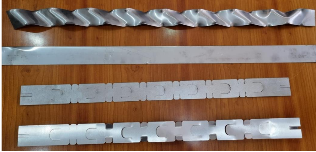
Şekil 4.14. Deney düzeneğinde kullanılan türbülatorlerin imalat görseli
