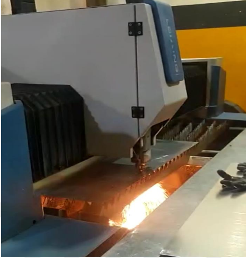
Şekil 4.2. Türbülötörlerin lazer kesim makinesi ile imalatı
