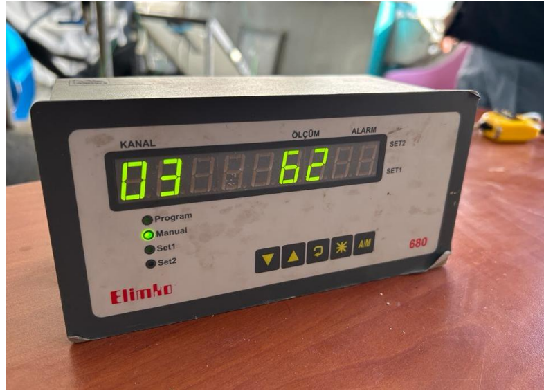
Şekil 4.10. ELİMKO E-680 dijital veri tarayıcı görseli
