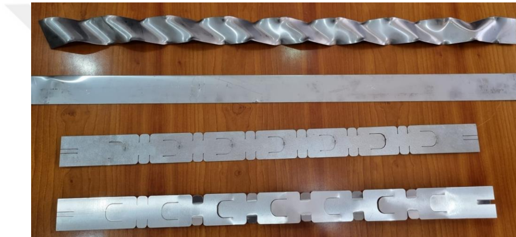
Şekil 4.14. Deney düzeneğinde kullanılan türbülatorlerin imalat görseli
