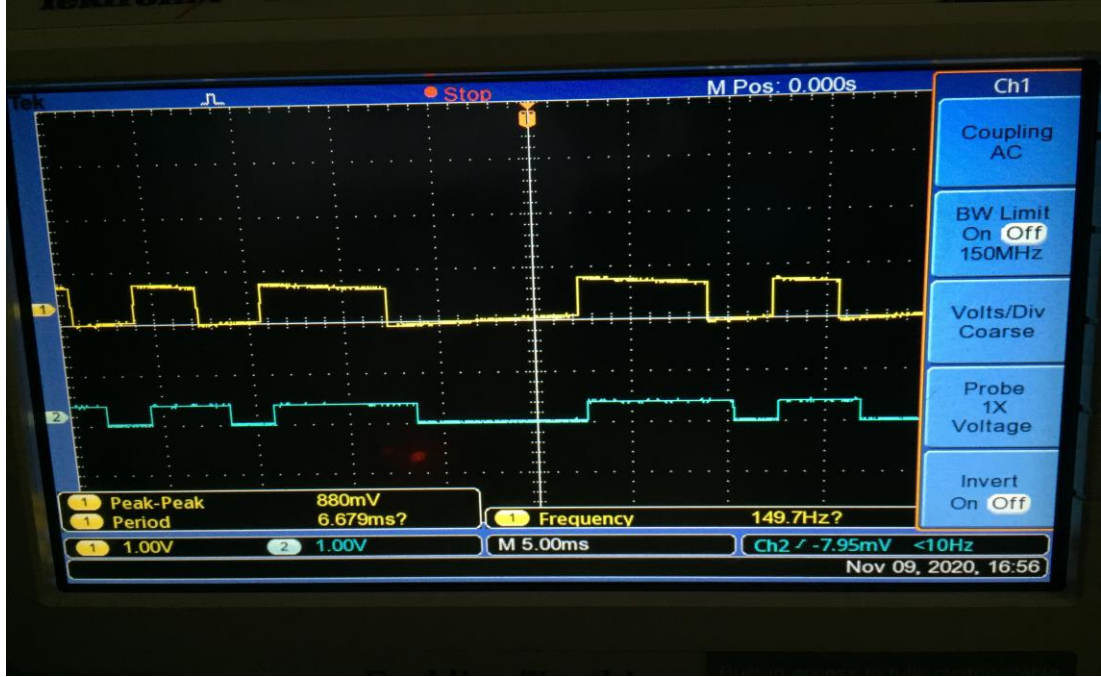
Şekil 4.10. Gönderilen ve alınan dijital sinyallerin osiloskop görüntüsü
