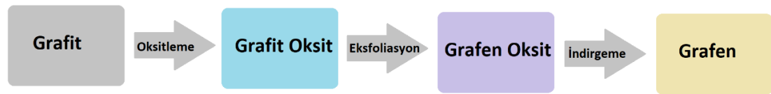
Şekil 4.12. GrO yoluyla grafen üretiminde yer alan çeşitli aşamaları gösteren bir akış diyagramı.
