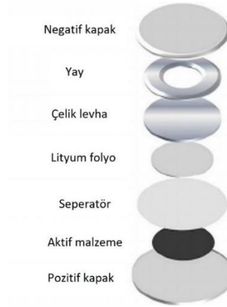
Şekil 5.9. CR2032 düğme tipi hücrenin birleştirilmesinin şematik gösterimi.
