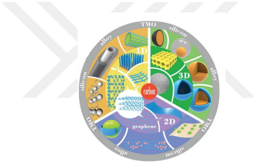
Şekil 3.8. Lityum iyon piller için en son anot malzemelerinin şematik diyagramı [68].
