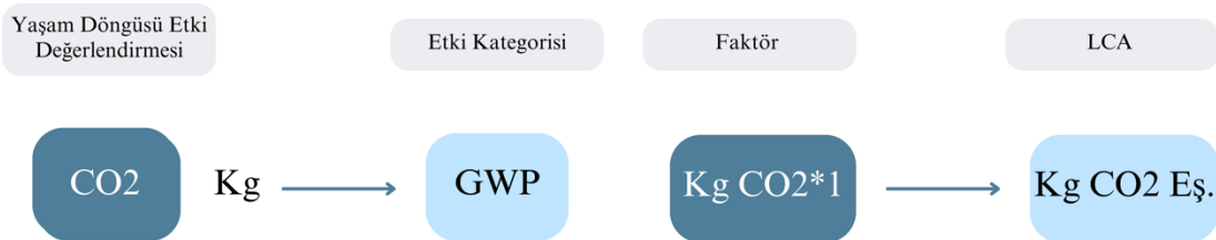
Şekil 3.3. LCIA küresel ısınma potansiyeli şematik olarak gösterme (Karaca, 2016)
