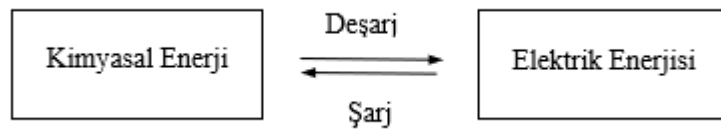
Şekil 2.4. İkincil pilin çalışma mekanizması.
