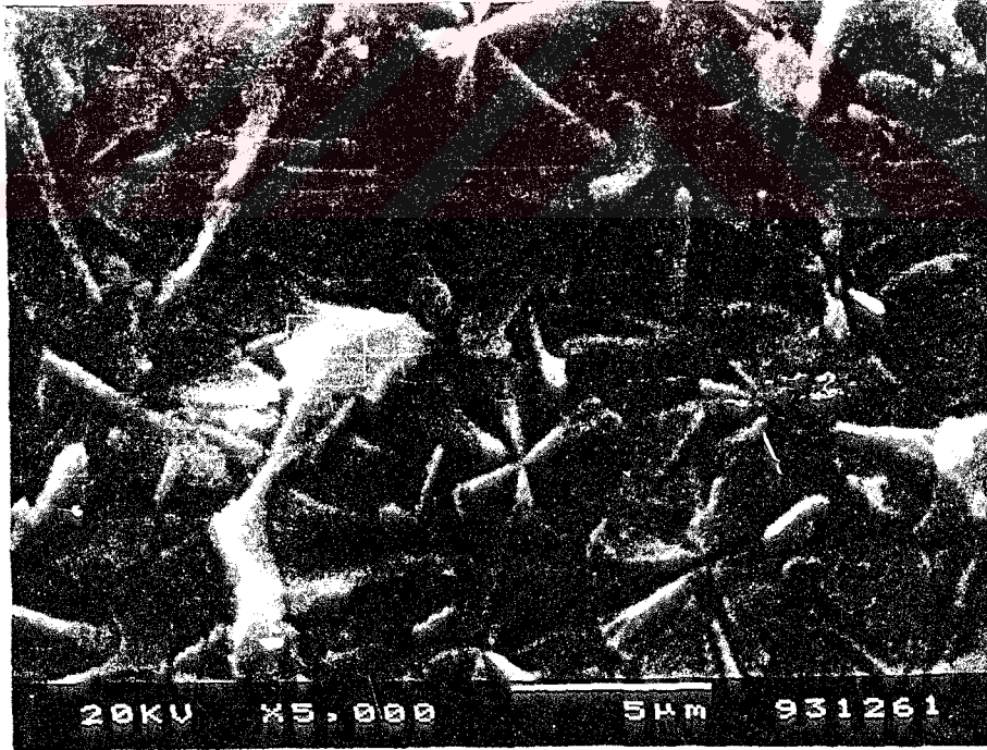
ŞEKİL: 6.12. 450°C'de 2, 510°C'de 1 1/2 Saat Isıl İşlem Görmüş Cal II'nin Mikroyapısı (X5000)
