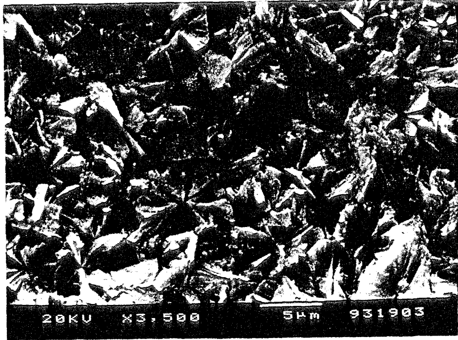
ŞEKİL: 6.22. 450/2, 510/2, 650°C'de 1 Saat Isıl İşlem Görmüş Cam II'nin Mikroyapısı (x3500)
