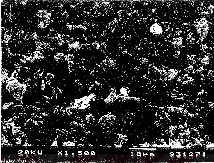
ŞEKİL: 6.28. 450/2, 510/2, 850°C'de 1 Saat Isıl İşlem Görmüş Cam II'nin Mikroyapısı (x1500)
