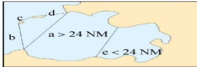
Şekil 2.8: Koy girişinde adalar olduğunda kullanılacak çapın belirlenmesi 15
