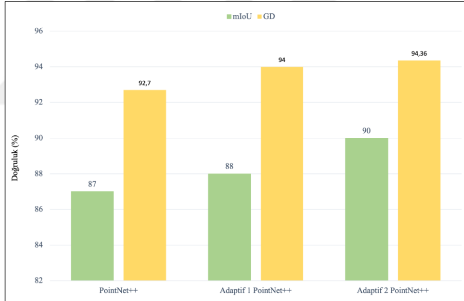
Şekil 33. Orijinal, Adaptif 1 ve Adaptif 2 (30×30) PointNet++ mimarilerinin düzensiz_DALES veri setleri üzerindeki GD ve ağırlıklı ortalama IoU doğruluklarının karşılaştırılması
