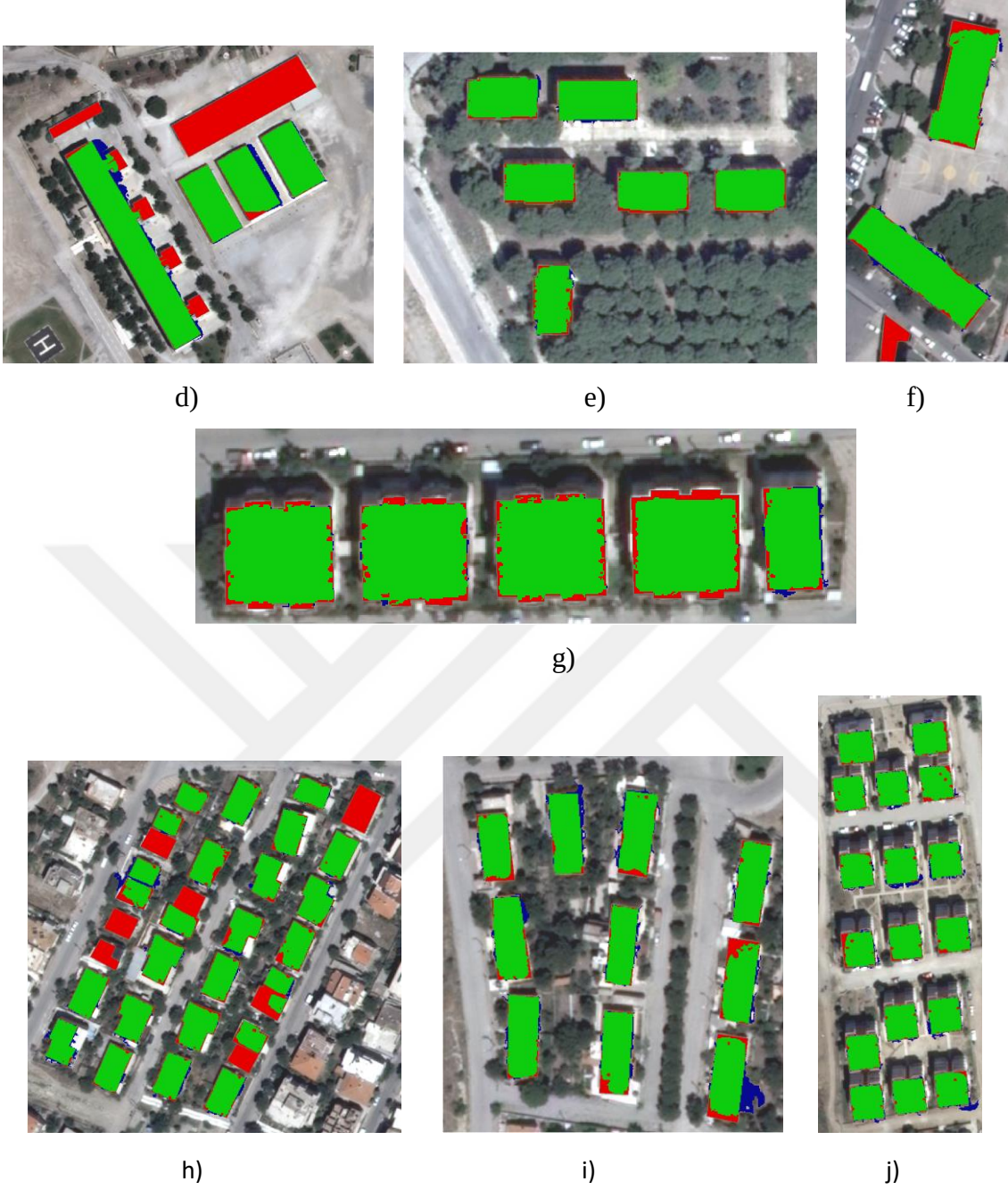
Şekil 4.4. ( a – j) Kombine algısal gruplama ve tohum bölge büyütme segmentasyonu yöntemi ile test alanlarında (TA_1 – TA_10) tespit edilen binalar
