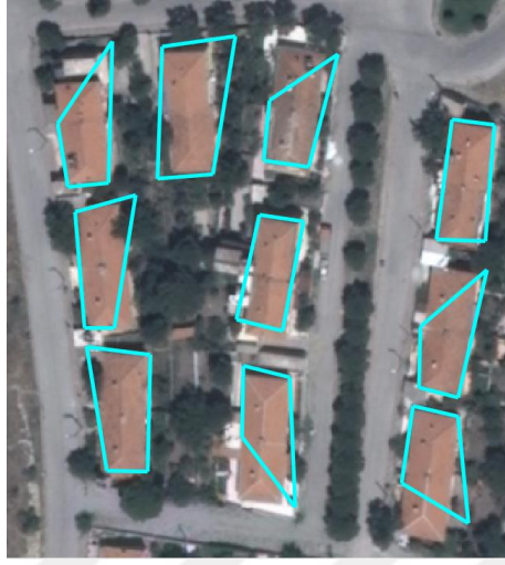
Şekil 4.3. ( a – j) Algısal gruptama kuralları ile TA_1 – TA_10 test alanlarında belirlenen bina sınırları
