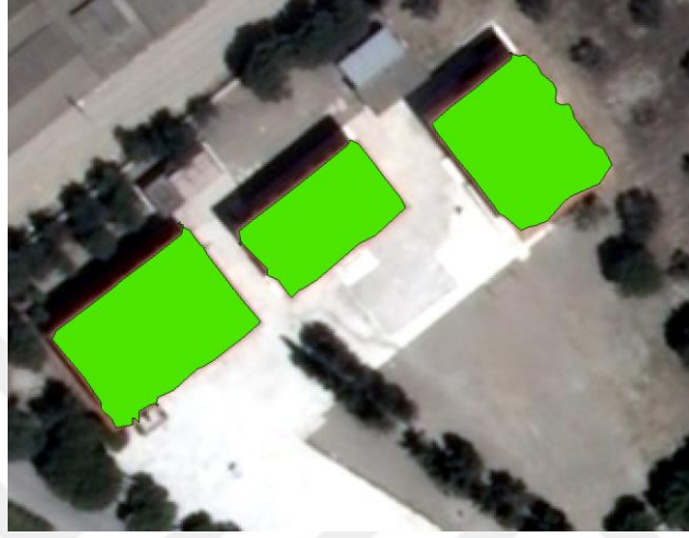
Şekil 3.28. TA_1 test alanı için, tohum bölge büyütme algoritması ile elde edilen binalar
