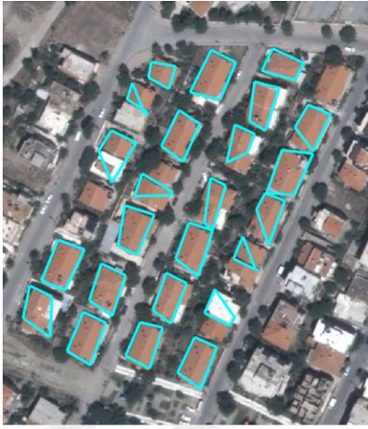
Şekil 4.3. ( a – j) Algısal gruptama kuralları ile TA_1 – TA_10 test alanlarında belirlenen bina sınırları
