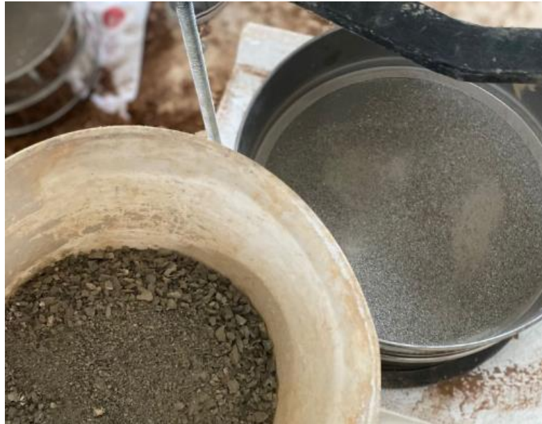
Şekil 87. Beton parçalarının elekten geçirilme işlemi
