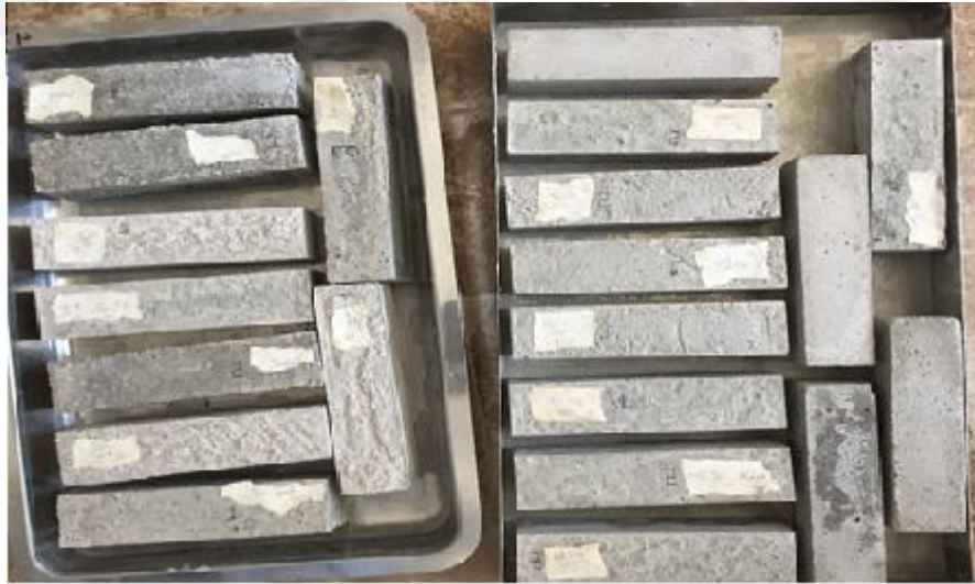
Resim 3.13 Çözeltiden çıkarılan numunelerin bekletilmesi
