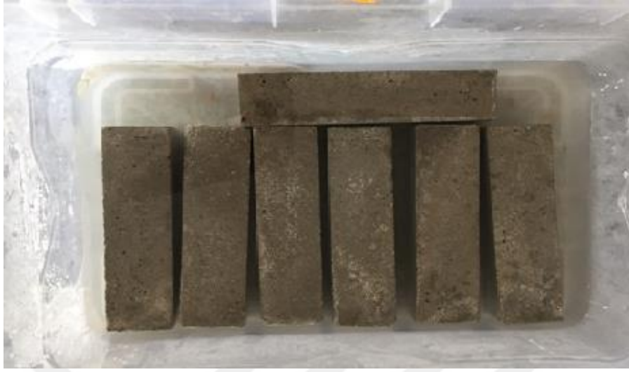
Resim 3.12 Numunelerin çözelti içinde bekletilmesi
