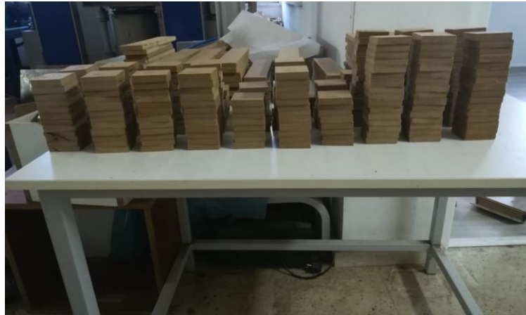
Şekil 2.6: Fiziksel ve mekanik testler için hazırlanan numuneler.
