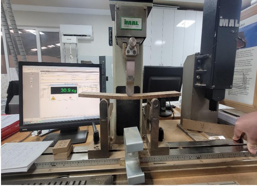
Şekil 3.6. Eğilme direnci ve eğilmede elastikiyet modülü testinin yapılışı.
