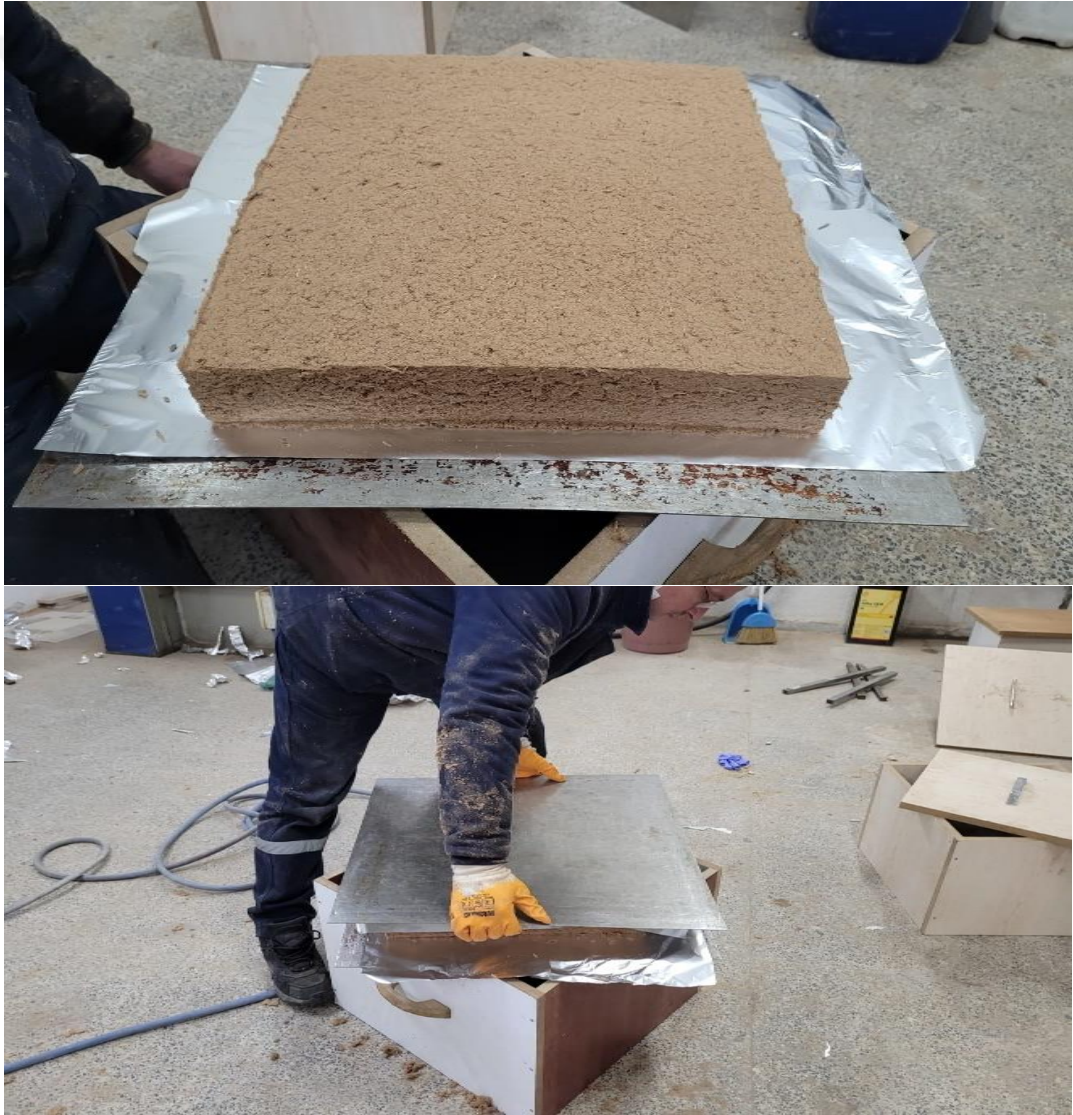
Şekil 3.2. Levha taslağının oluşturulması ve ön presleme.
