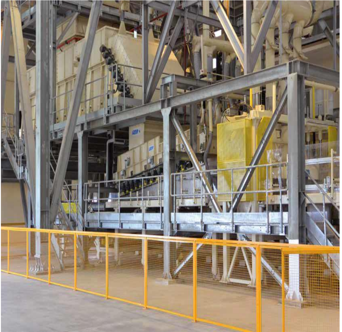
řekil 2.20. IMAL PAL firmasına ait serme ünitesi [35].
