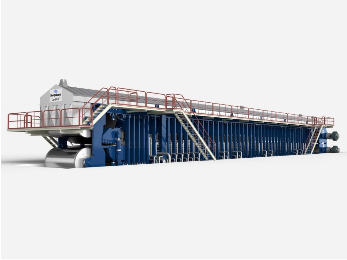
Şekil 2.25. Sürekli sıcak pres [40].
