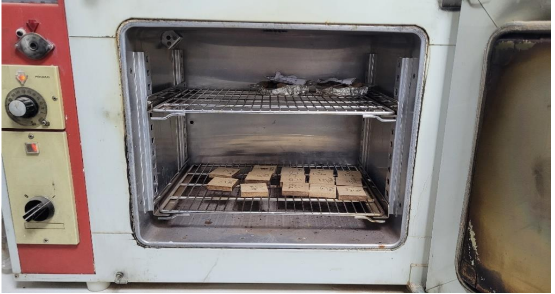
Şekil 3.4. Rutubet miktarı ölçümü için örneklerin etüv içerisine yerleştirilmesi.
