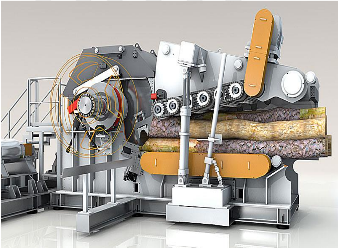
Şekil 2.8. Tamburlu yongalama makinesi şematik görüntü [29].
