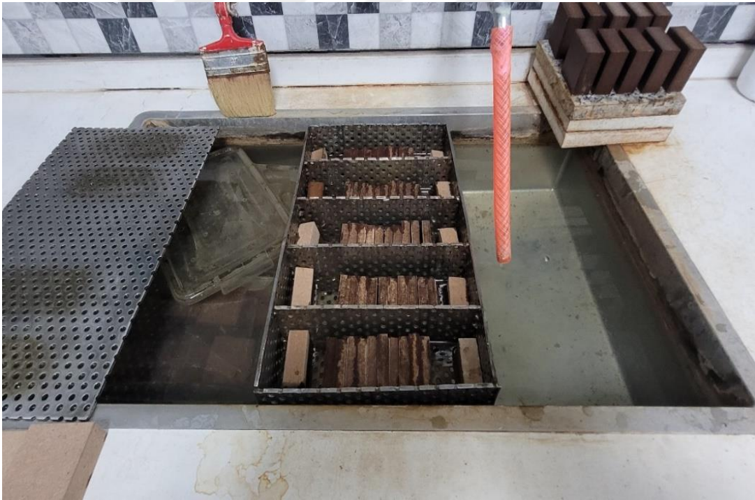
Şekil 3.5. Su alma ve kalınlık artımı testleri için örneklerin suda bekletilmesi.
