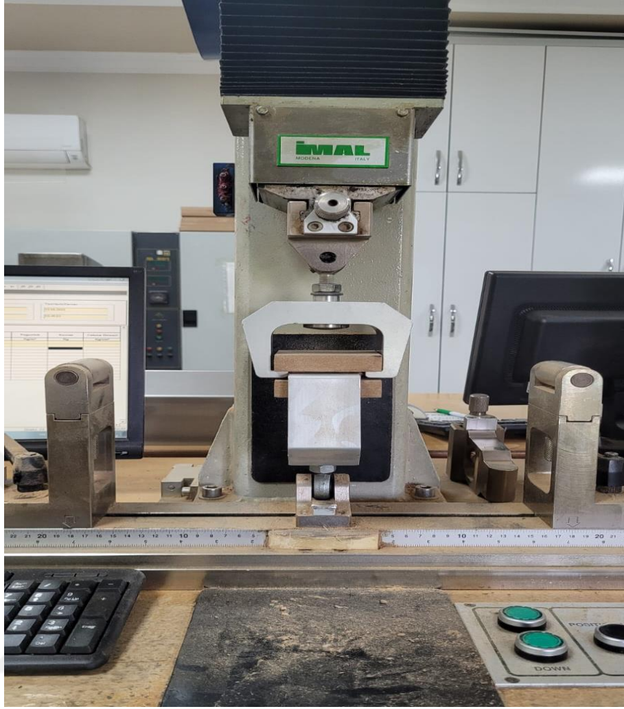
Şekil 3.7. Yüzeye dik yönde çekme testi yapılışı.
