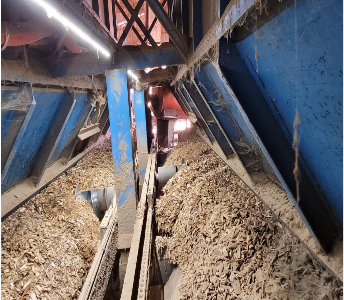
Şekil 2.10. Yongaların silolardan helezonlar vasıtasıyla boşaltılması.
