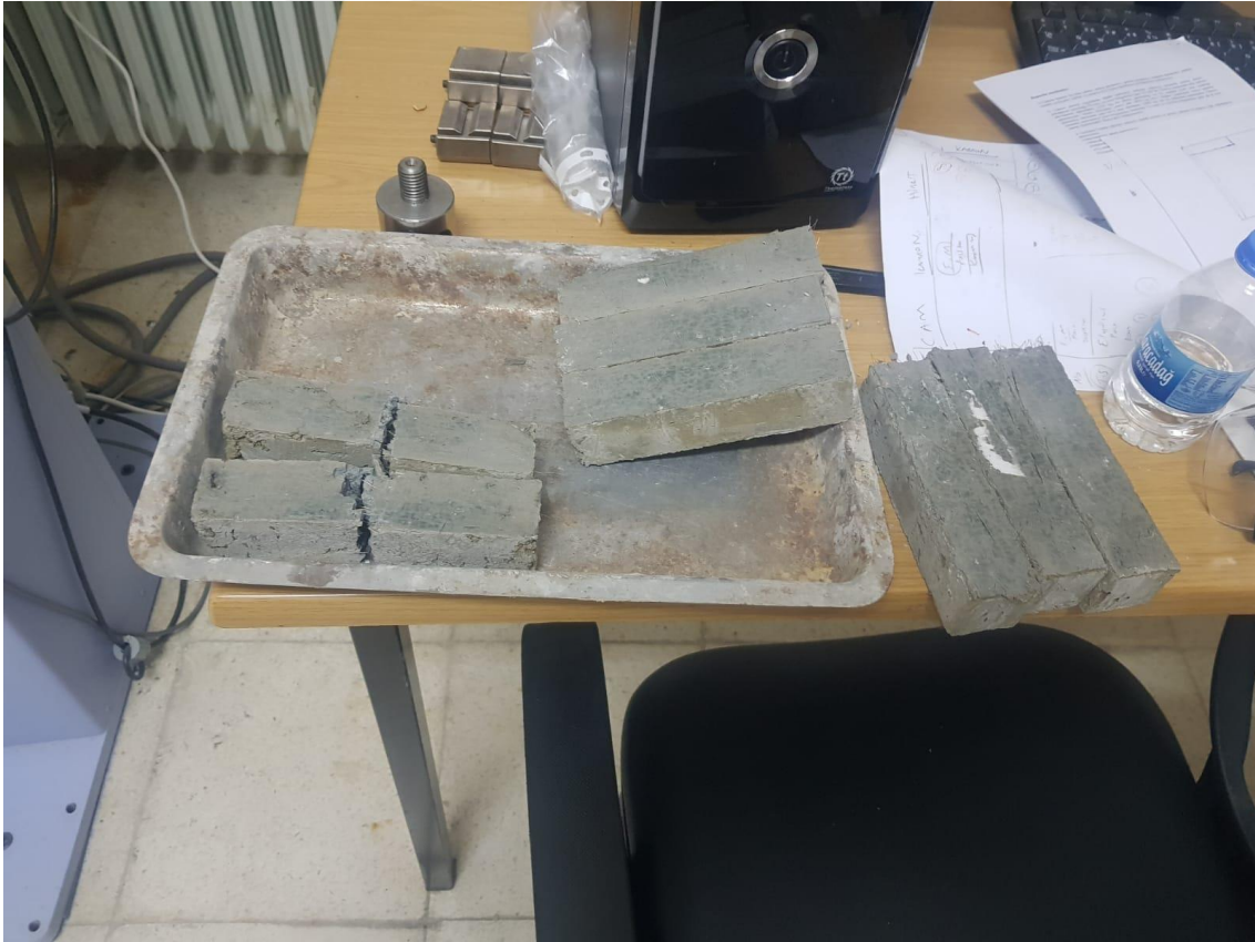
Şekil 3.8 : Lif takviyeli geopolimer kompozitler
