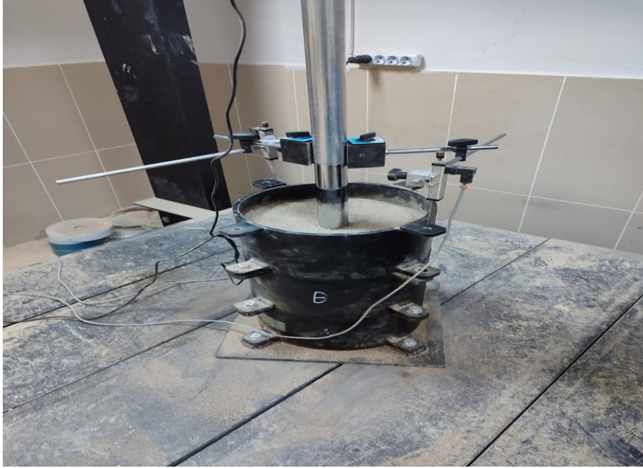
Şekil 3. 16 : Yerinde dökme geopolimer kazığının deplasman ölçer yerleşimi
