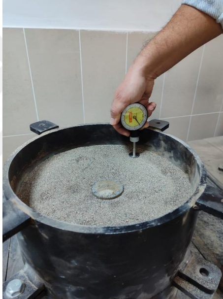
Şekil 3.12 : El penetrometresi ile sıkılaşma kontrolünün yapılması
