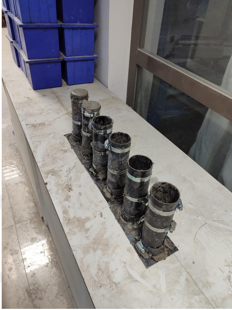
Şekil 3.9 : Farklı boyutlardaki lif takviyeli geopolimer kazıklar
