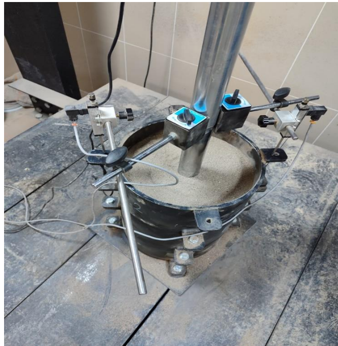
Şekil 3.18 : Çakma geopolimer kazığının deplasman ölçer yerleşimi
