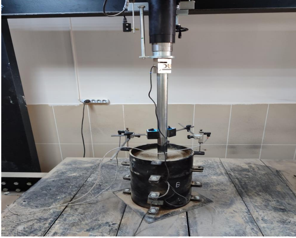
Şekil 3. 13 : Model temel için deplasman ölçer yerleşimi
