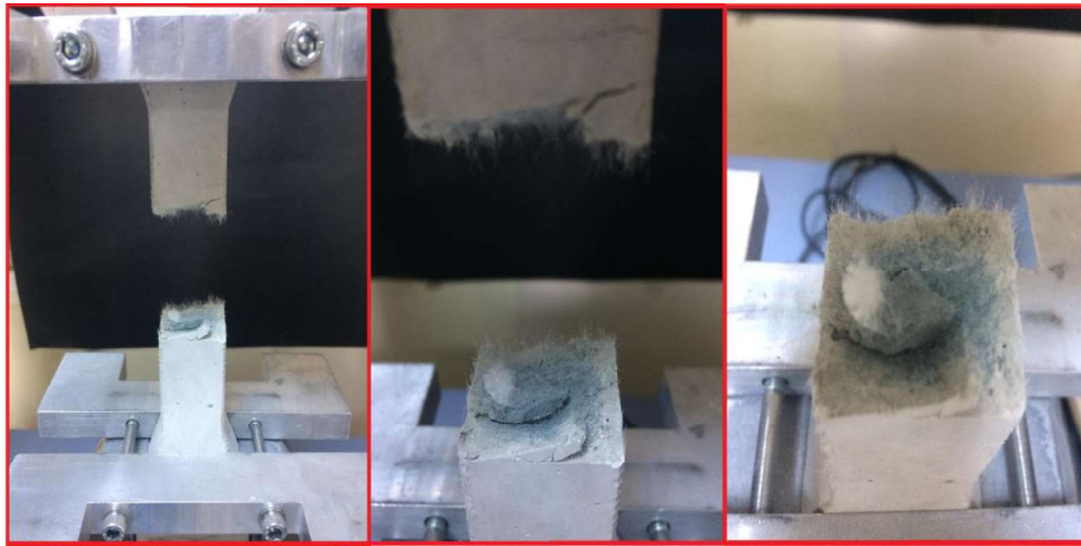
Şekil 4.16 Lifli kompozitlerin üretim kaynaklı oluşabilecek hatalı/boşluklu yapısı (Kişisel arşiv, 2019)
