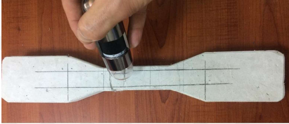
Şekil 3.7 Optik el mikroskopi yardımı ile çatlak sayılarının belirlenmesi (Kişisel arşiv, 2020)
