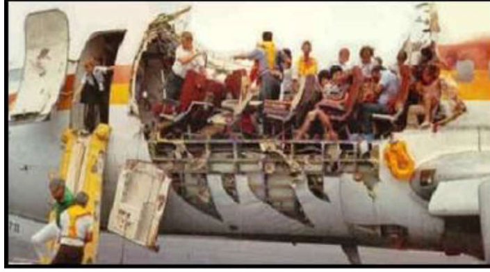
Şekil 1.7 1988 yılında metal yorulgunluk kaynaklı yaşanan Boeing 737 uçağının yırtılan gövdesi (Stere ve Baran, 2011)
