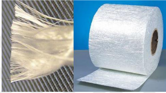
Şekil 3.3. Cam elyaf demeti ve kırılmış cam elyaftan üretilmiş keçe
