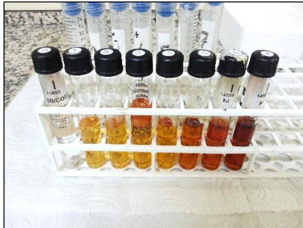
Şekil 2.2 Farklı odun talaşı derişimlerine sahip hidroliz örneklerinin Fenol – Asit spektrofotometrik yöntem ile toplam şeker analizi
