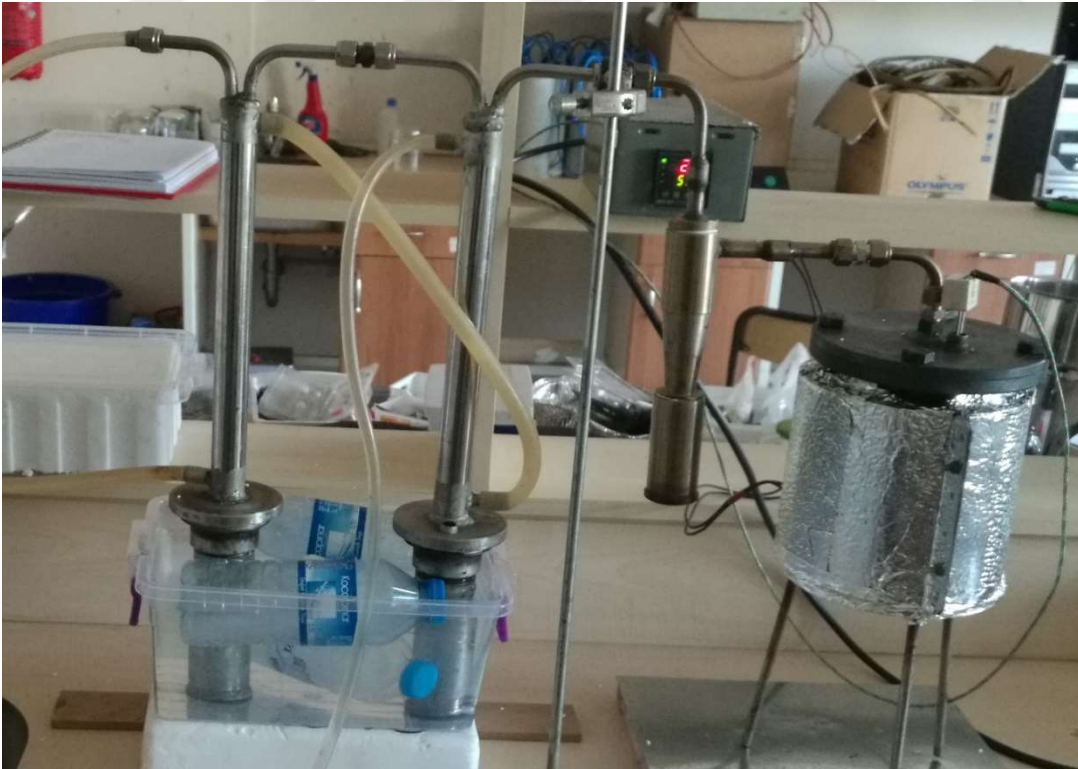
Şekil 3.2. Kullanılan sabit yataklı piroliz sisteminin görüntüsü
