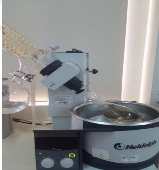
Şekil 2.15. Ekstrakt içindeki etil asetatın buharlaştırılması
